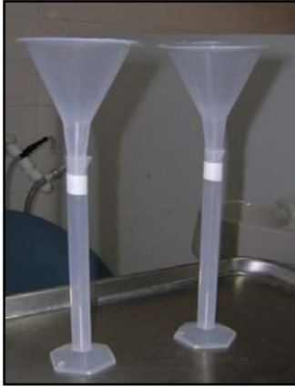
A.4.1: Probetas para recolección de STNE y STE con sus embudos correspondientes.
