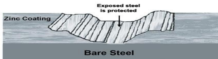
Ilustración 8 Figura 8: Protección catódica. Fuente: www.galvanizeit.org
