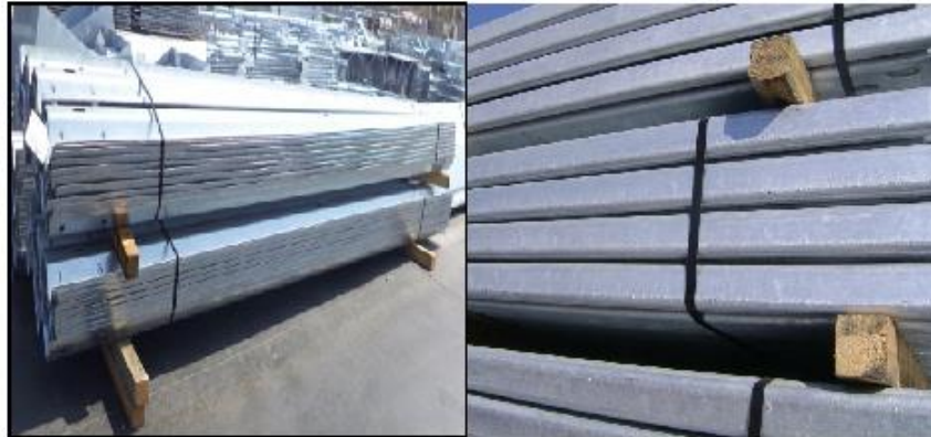
Figura 4. Almacenamiento adecuado de defensas galvanizadas. Estas defensas están con Angulo de inclinación y sin exceso de aplastamiento, lo que permite el escurrimiento del agua, para evitar formación de óxido blanco.
