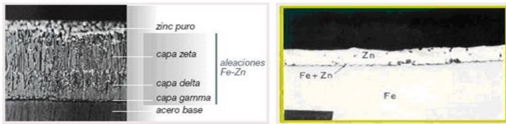
Ilustración 12 Comparación micrografías, proceso discontinuo y continuo. Fuente: www.ingemecanica.com y www.construmatica.com
