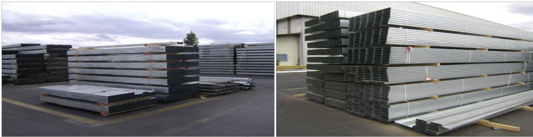
Ilustración 4 Almacenamiento de lotes de acero galvanizado a intemperie.
