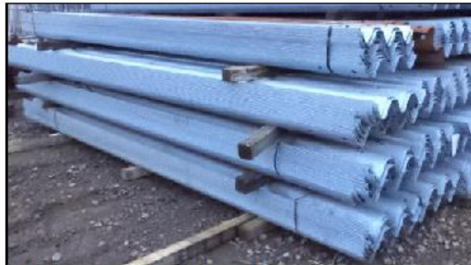
Figura 2. El almacenamiento inadecuado de defensas galvanizadas, falta de inclinación y aplastamiento, favorece la generación de óxido de zinc sobre de la superficie del revestimiento.
