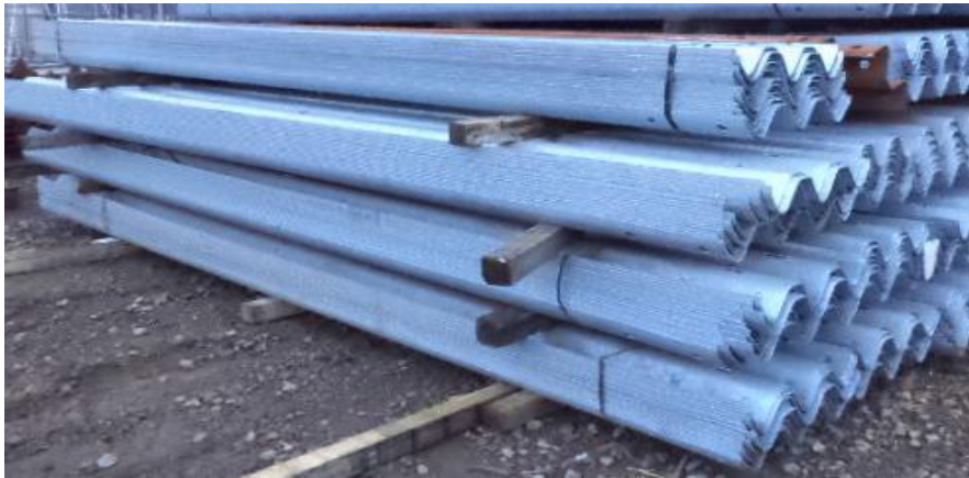
Ilustración 20 Almacenamiento inadecuado favorece generación de óxido de zinc sobre superficie del revestimiento. Fuente: www.bbosch.cl
