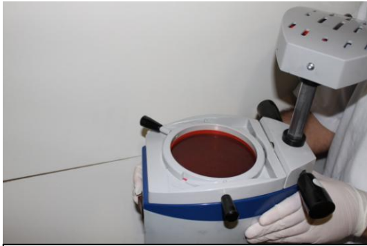
Figura 6: Estampadora PLASTVAC P7 Bio Art con lámina coloreada en posición para el procedimiento de estampado.
