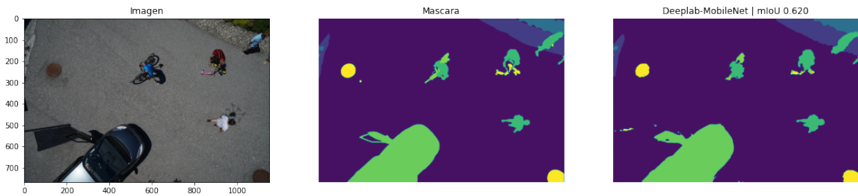
Figura 5.5: Resultado de segmentación semántica a una imagen del conjunto de prueba, se obtiene una media IoU 62%, arquitectura DeepLab. Elaboración propia.
