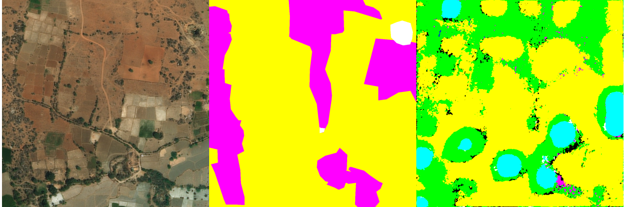
Figura 5.15: Resultado de segmentación semántica al conjunto de prueba imágenes por satélites, arquitectura DeepLab. Elaboración propia.
