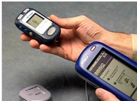
Figura 11. alinear los puertos de infrarrojos en los programadores de N'Vision e iCon [33].
