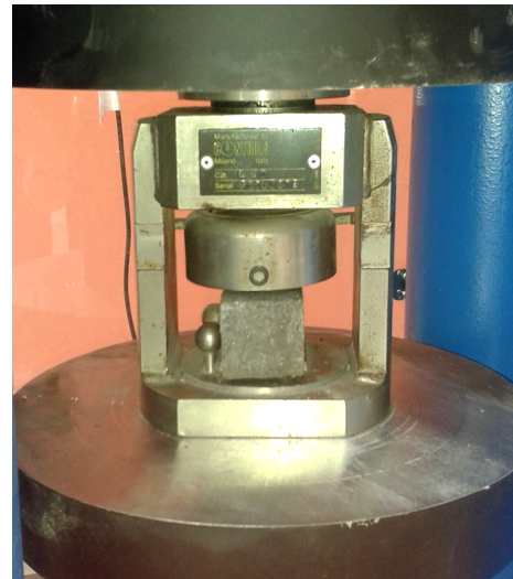
Figura 5.11 Probeta RILEM sometida a ensayo de compresión
