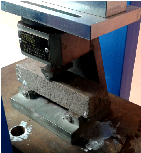
Figura 5.10 Probeta RILEM sometida a ensayo de flexión
