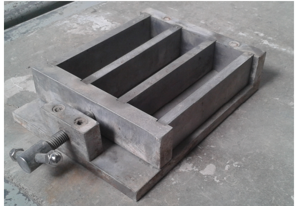
Figura 3.2 Molde para probeta Resistencia Mecánica. Fuente: Elaboración propia
