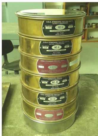
Figura 3.5 Tamices – Laboratorio de Hormigón Fuente: Elaboración Propia
