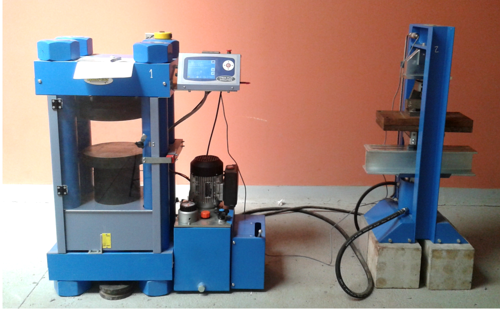
Figura 3.6 Prensa universal Cyber-plus evolution. Fuente: Elaboración propia.
