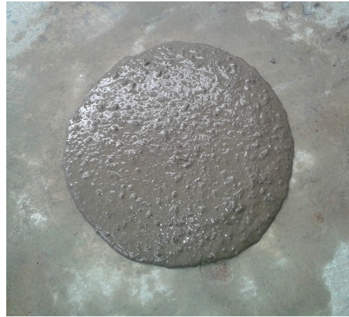
Figura 5.3 Extendido ensayo mesa de sacudida
