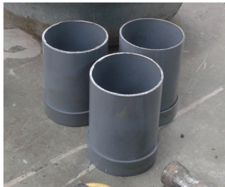
Figura 3.3 Molde para probeta Absorción de agua. Fuente: Elaboración Propia
