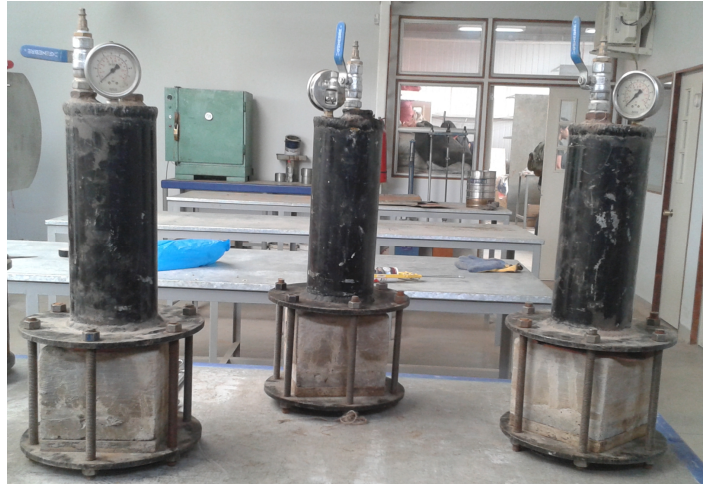
Figura 5.17 Probetas en equipos para ensayar permeabilidad al agua Fuente: Elaboración propia
