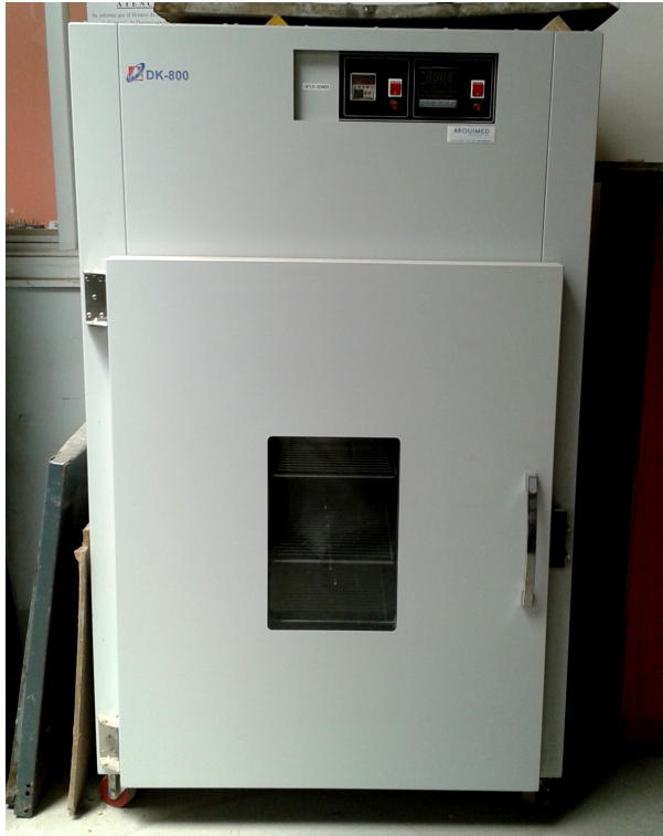
Figura 3.4 Horno – Laboratorio de Hormigón Fuente: Elaboración Propia
