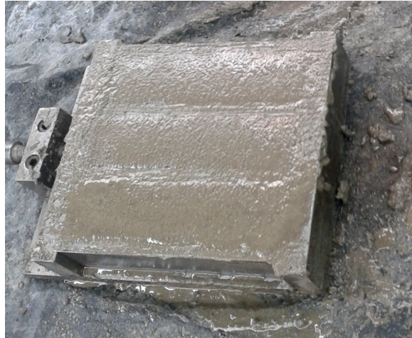
Figura 5.9 Elaboración probetas RILEM
