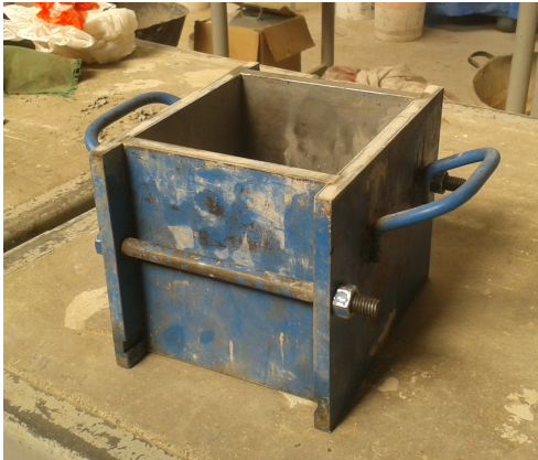
Figura 3.1 Molde para probeta Permeabilidad. Fuente: Elaboración propia
