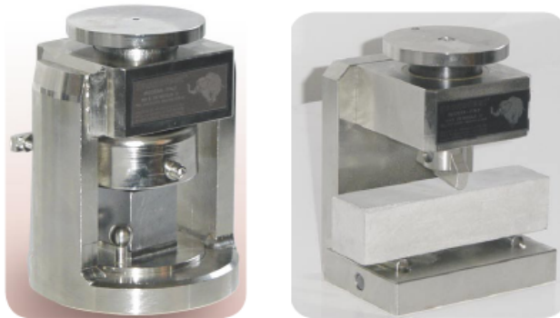
Figura 3.7 Dispositivos de compresión y flexión respectivamente Fuente: Tecnotest, Cementos y Morteros.
