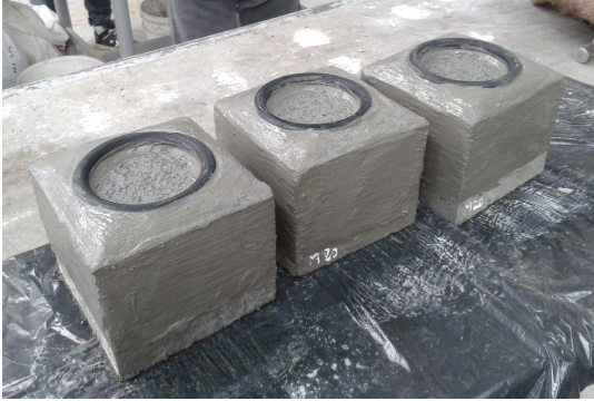
Figura 5.16 Probeta para permeabilidad con anillo de goma Fuente: Elaboración propia
