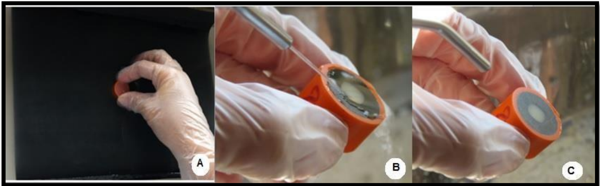
Fig.7 A) Lija 600. B) Lavado de superficie C) Secado con spray de la superficie.
