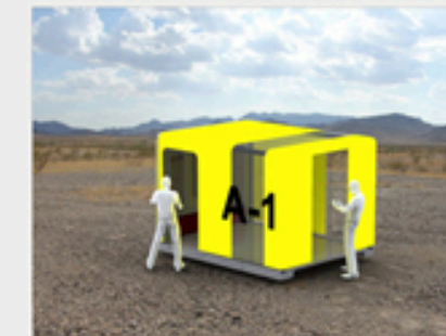
Se encastra la estructura al siguiente extremo del habitaculo cubriendo la totalidad con la lona
