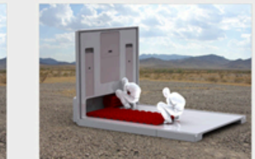
En la situación de dormir, se sacan y se extienden los colchones de modulos tubulares, los cuales brindad comodidad y ahorro de espacio
