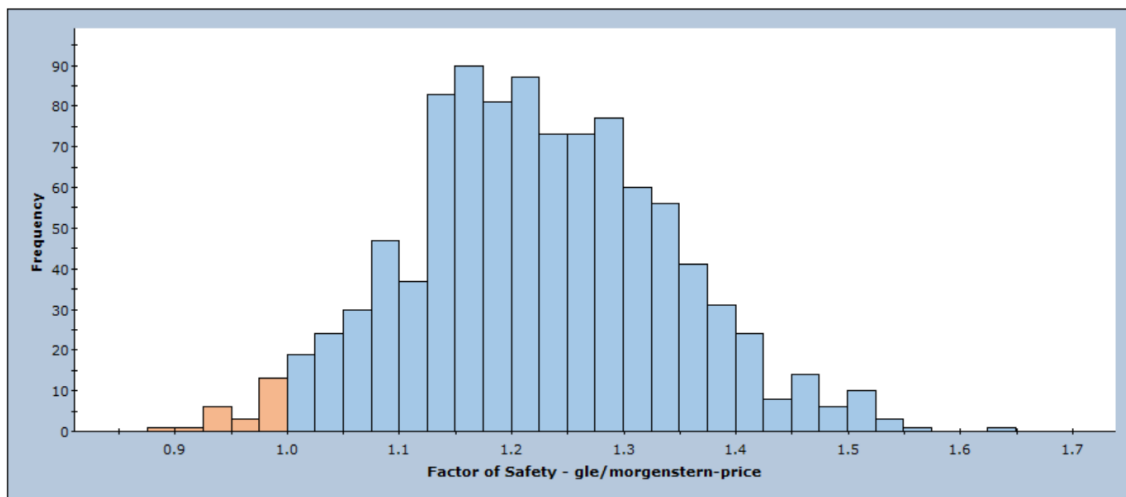
Figura 6.10 - Frecuencias de los factores de seguridad en el análisis probabilístico, caso pseudo-estático, condición optimizada.
