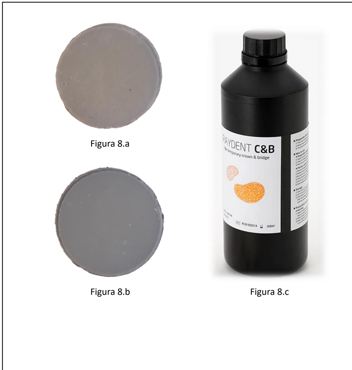
Figura 8.a: Cuerpo de prueba sometido a ciclo de postcurado en horno SHERAflash-light plus . Figura 8.b: Cuerpo de prueba sometido a ciclo de postcurado en horno de cosmético Meline . Figura 8.c: Resina imprimible 3D Materials Raydent C&B
