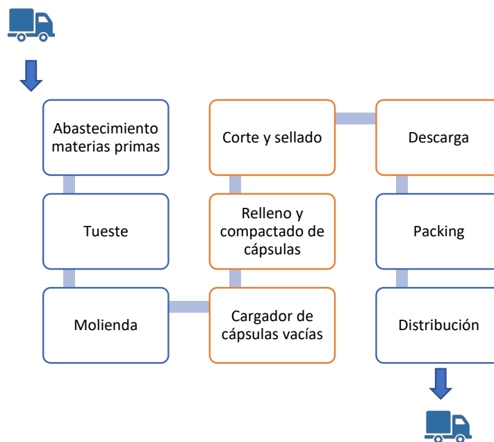
Ilustración 6 Conjunto de actividades críticas para producción de cápsulas de café. Elaboración propia.
