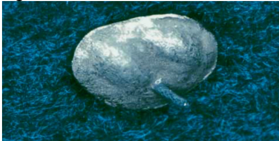
Fig. 40: Patrón de resina retirado
