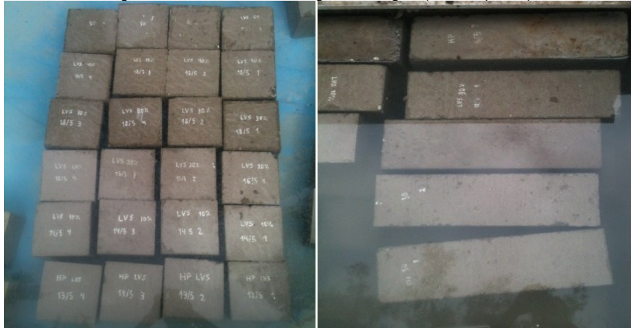
Figura 3.17: Probetas sumergidas en agua (vista superior)
