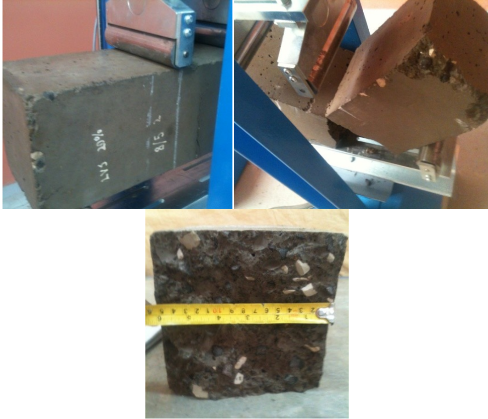
Figura 4.2: Imágenes ensayo tracción por flexión.
