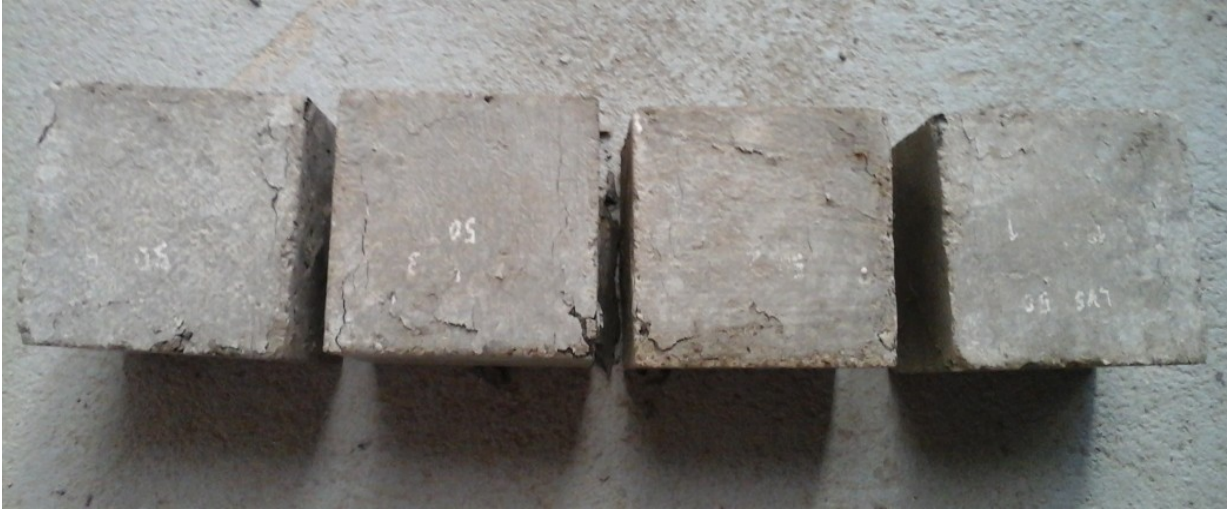
Figura 4.3: Muestras ensayo compresión con 50% LVS.
