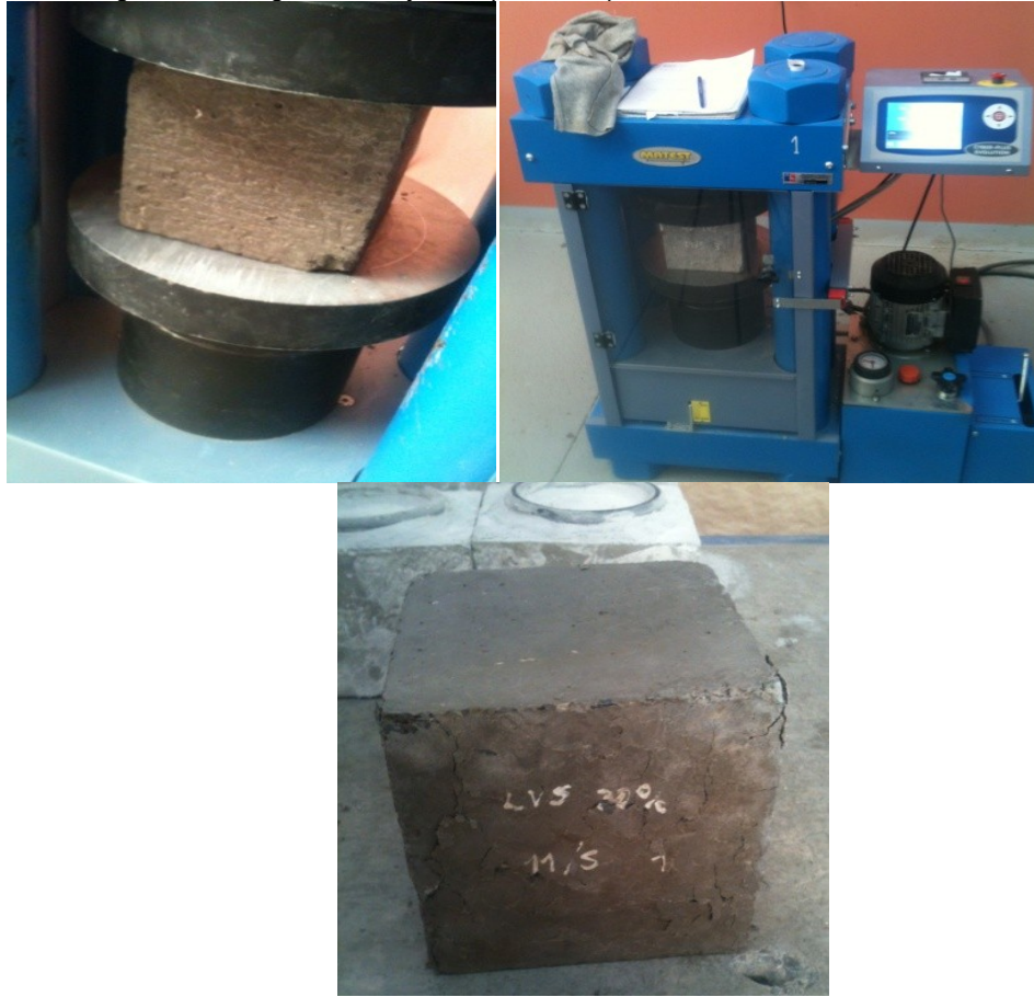
Figura 4.1: Imágenes ensayo compresión a probeta cubica con 30% LVS.
