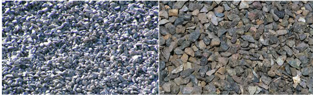
Figura 3.10: Arena negra Dn 4,75mm y gravilla Dn 15 mm.
