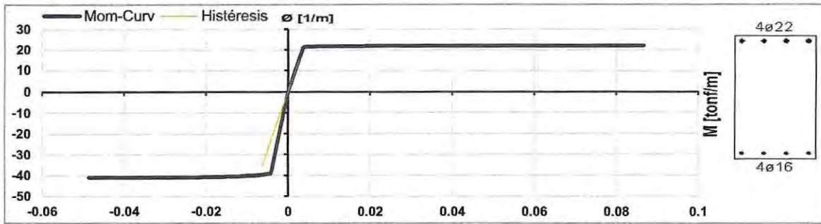
Figura 6.27: Diagrama momento-curvatura Viga 35x70, DBF.
