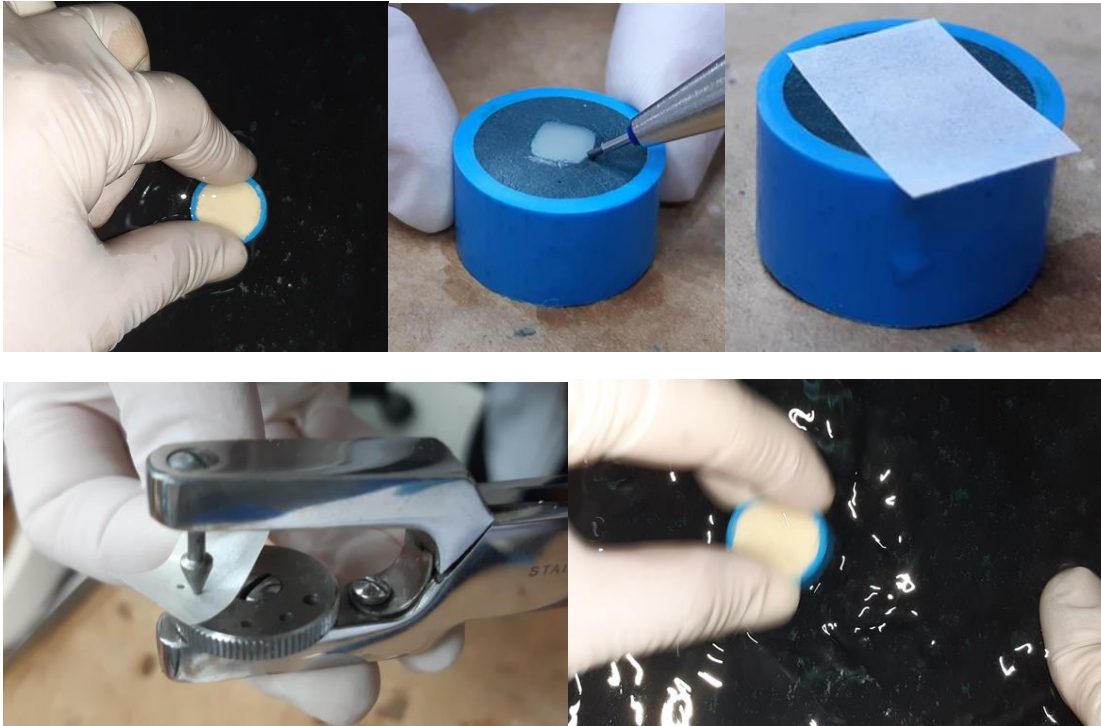
Preparación de la superficie del cuerpo de prueba. Fig IV: Lijado inicial; Fig. V: Marca del perímetro de la superficie; Fig VI: Posicionamiento de cinta doble faz; Fig. VII: Perforación de cinta doble faz con perforador de goma dique; Fig. VIII Segundo lijado del cuerpo de prueba.
