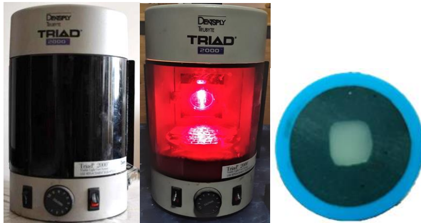
Figuras I y II: Unidad fotoactivadora Triad 2000 (Dentsply), apagada y en funcionamiento respectivamente. Figura III: Cuerpo de prueba fabricado con tubo de PVC, compuesto de modelar y resina compuesta indirecta In:Joy.
