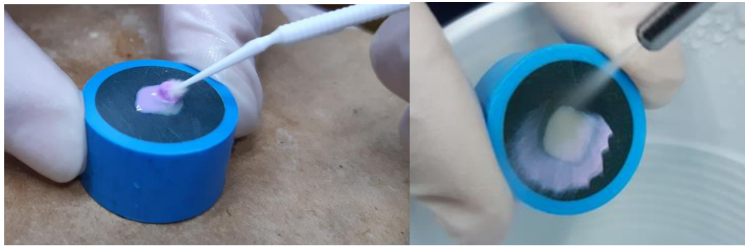
Fig XI y XII: Aplicación y lavado respectivamente de Pasta de Limpieza en el cuerpo de prueba.
