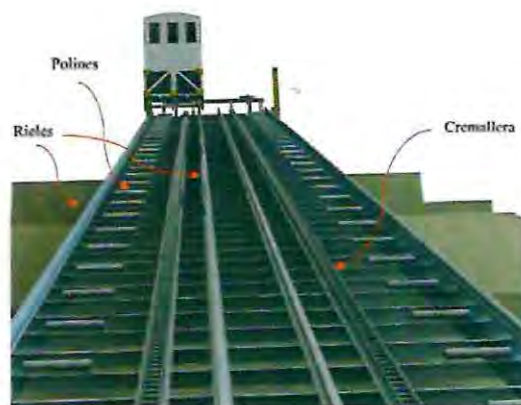
Imagen 159 Leyton, E. (2017). Plano de rodadura ascensor.
