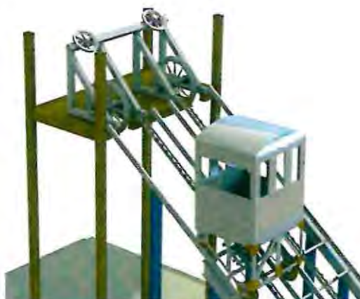
Imagen 153 Leyton, E. (2017) Disposición sala de poleas respecto al plano de rodadura, ascensor
