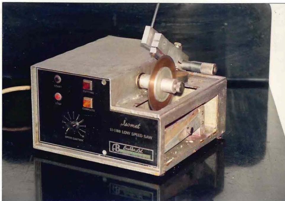
Fotografía N°19: Recortadora ISOMET (Büehler Ltd.) Universidad Técnica Federico Santa María.
