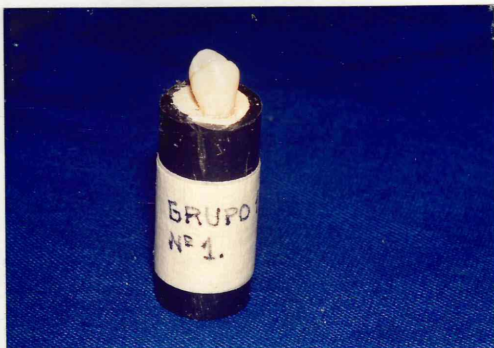
Fotografía Nº1: Troquel constituido de un trozo de manguera de poliuretano y yeso piedra.
