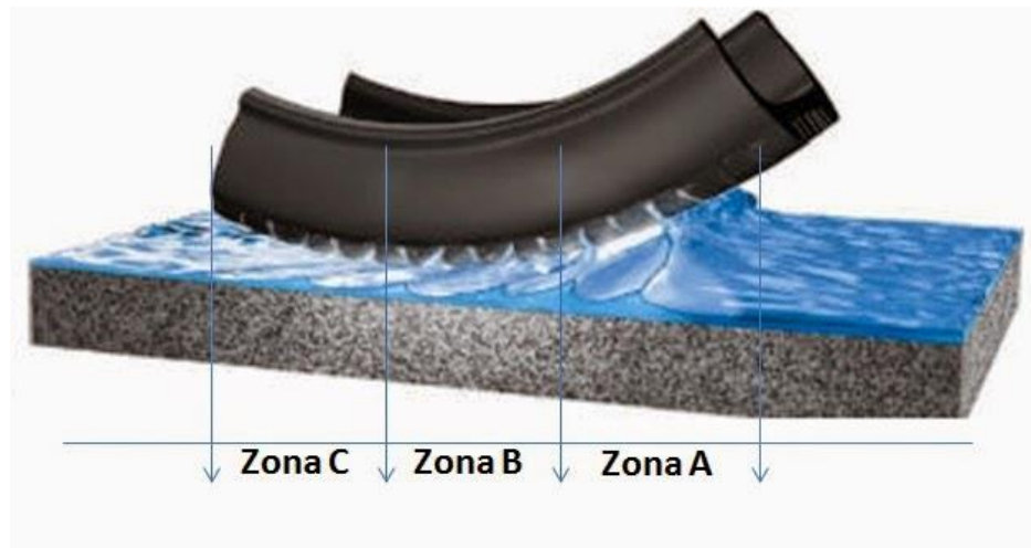
Figura 5.7- Zonas de contacto entre la Rueda y el Pavimento bajo efectos de la Velocidad. Fuente [39]
