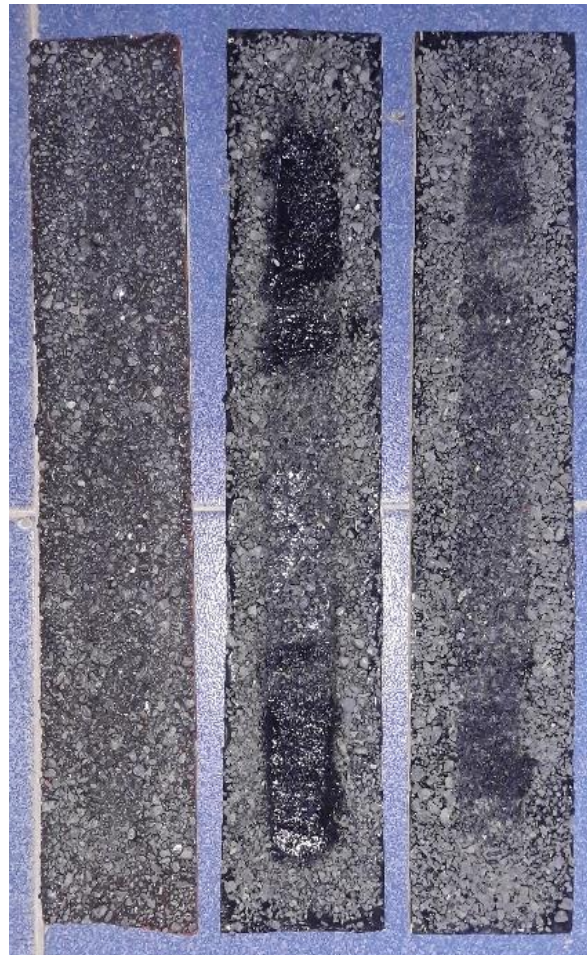
Figura 7.10- Resultado Final de las Probetas posterior al Ensayo de Rueda Cargada.
