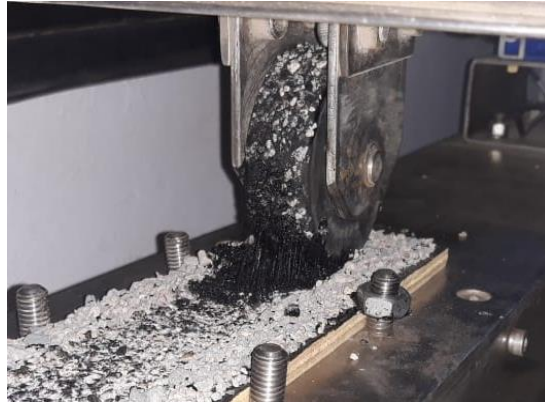
Figura 7.9- Problema producido por Exudación de las Emulsiones Asfálticas de Quiebre Rápido.
