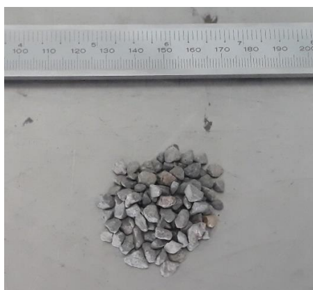
Figura 4.4- Agregado Pétreo del Aconcagua, con tamaño de partículas entre 1,3 -4 [mm].
