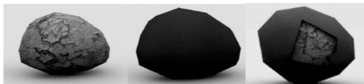
Figura 7.20- Fenómeno de Contracción de las Emulsiones denominado “ Stripping ”.
