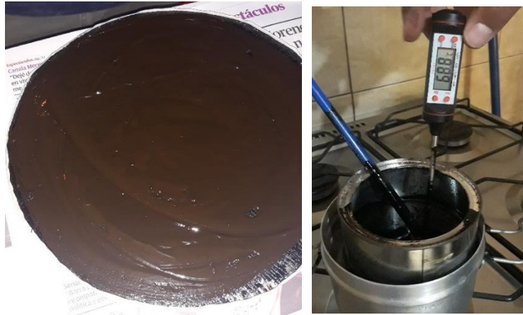
Figura 7.13- Aplicación de las Dosis de Ligantes sobre Probetas Circulares destinadas a la Abrasión.
