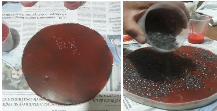
Figura 7.14- Aplicación de Agregados sobre Probetas destinadas a la Abrasión.
