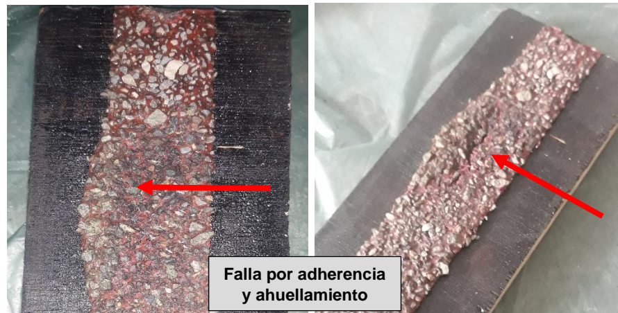
Figura 7.25- Falla Presentada en algunas Probetas, debido a la falta de Adherencia y Ahuellamiento.
