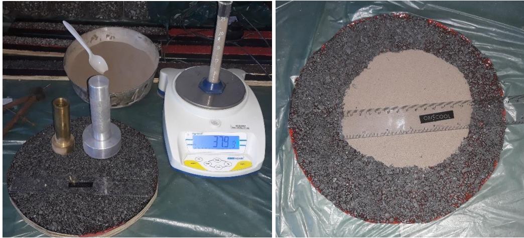
Figura 7.29- Instrumento para Medir la Macro Textura (Circulo de Arena).
