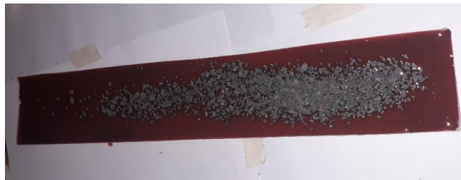
Figura 7.6- Aplicación del Agregado sobre los Ligantes.
