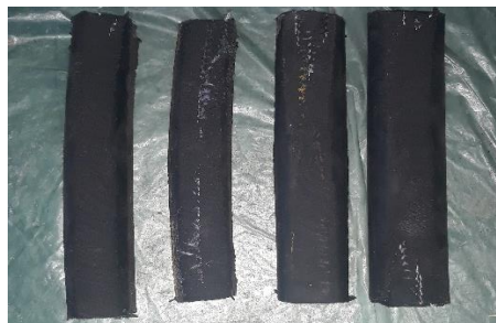
Figura 7.28- Desgaste excesivo de Gomas Utilizadas en la Máquina de Abrasión.
