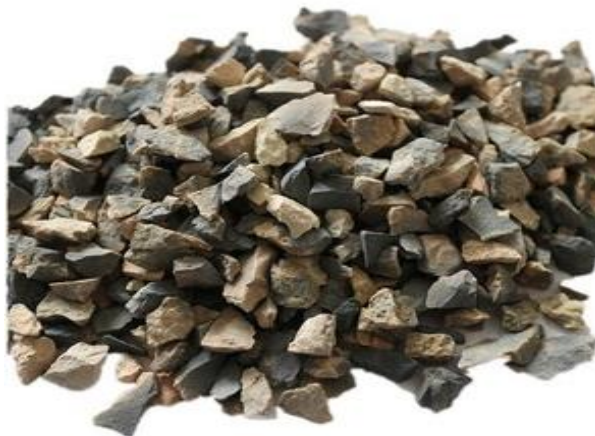
Figura 5.2- Forma de la Bauxita Calcinada Chancada.
