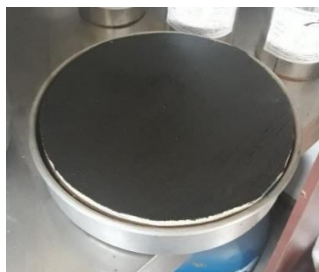
Figura 7.12- Imprimación de Probetas Circulares para Ensayo de Abrasión.
