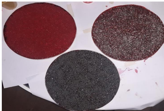
Figura 7.15- Curado de Probetas destinadas al Ensayo de Abrasión.
