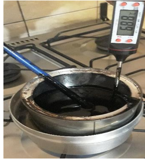
Figura 7.5- Aplicación de los Ligantes sobre Probetas de Maderas Imprimadas.
