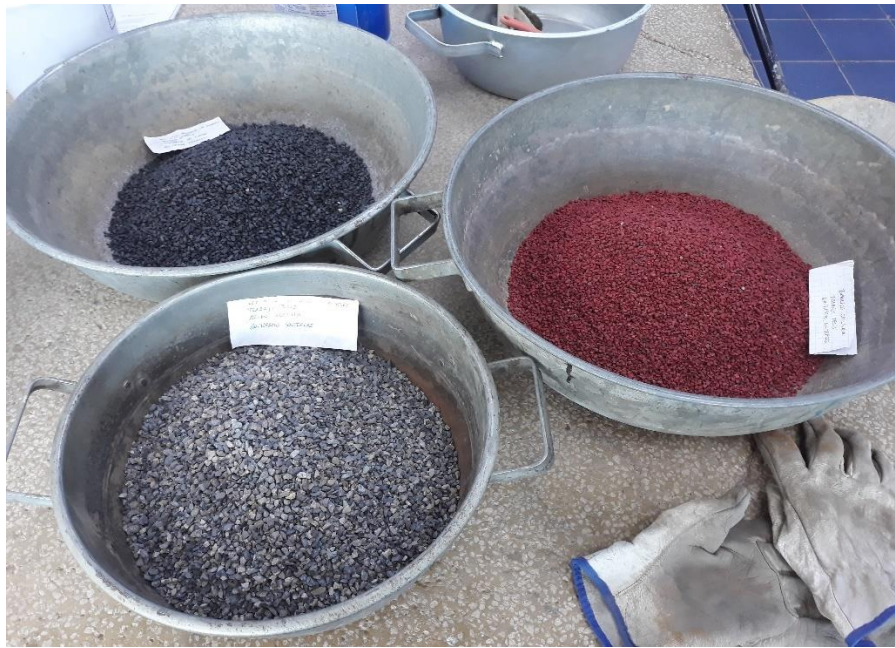
Material retenido tamiz N°12, posterior al ensayo
