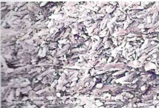
Ejemplo de fractura tipo I: superficie de fractura en el grupo microabrasión-AF. La capa adhesiva fue totalmente des-adherida desde la superficie cerámica.
