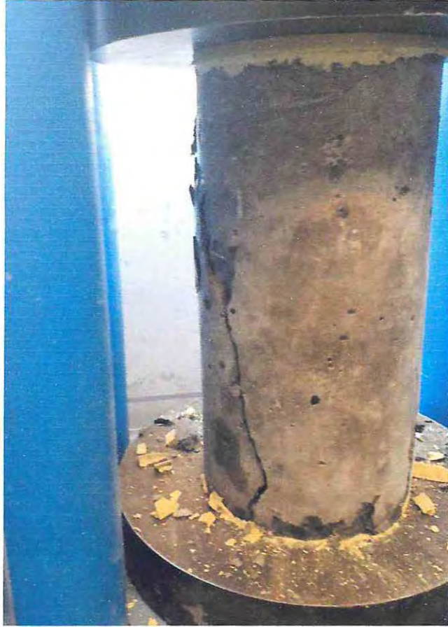
Figura 5.6 Probeta Cilíndrica después de ser ensayadas
