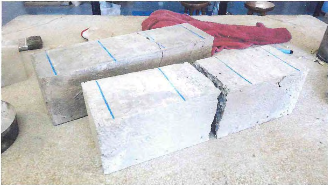
Figura 5.7 Probetas Prismáticas Después de ser ensayadas
