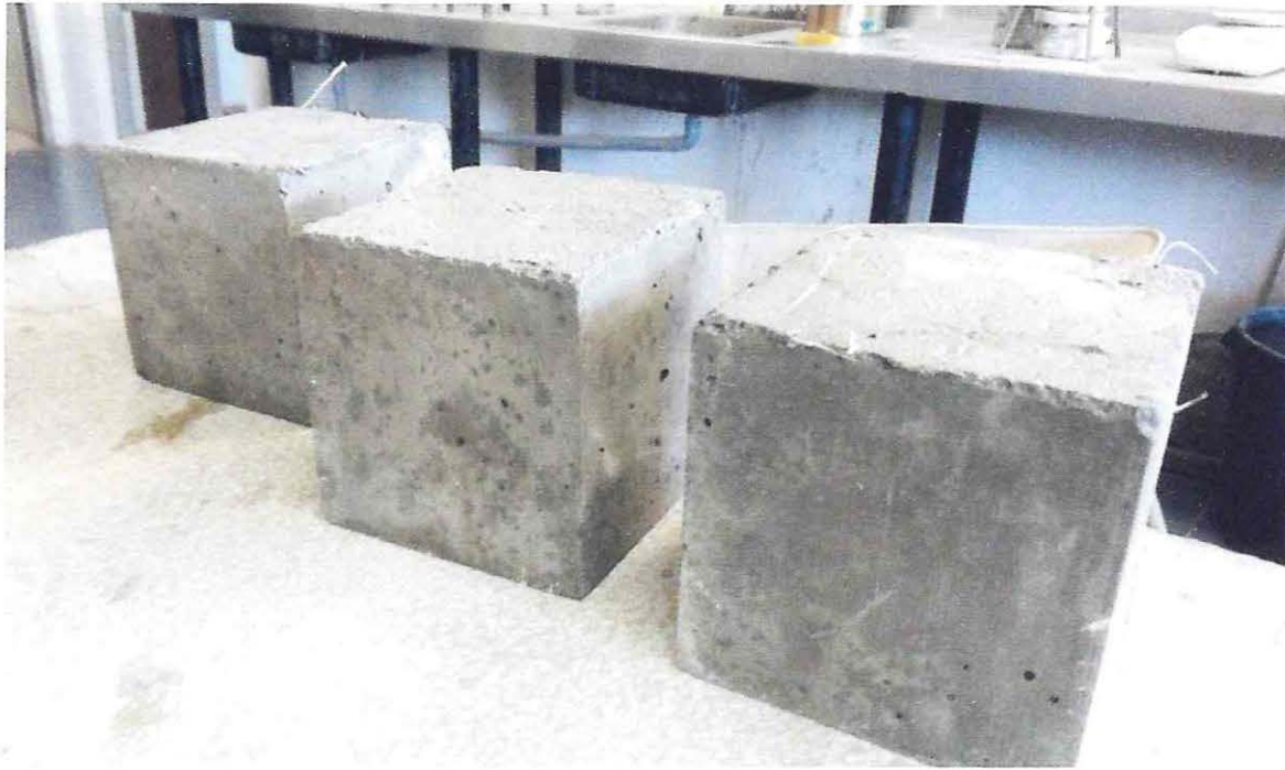
Figura 5.4 Probetas Cúbicas antes de ser ensayadas
