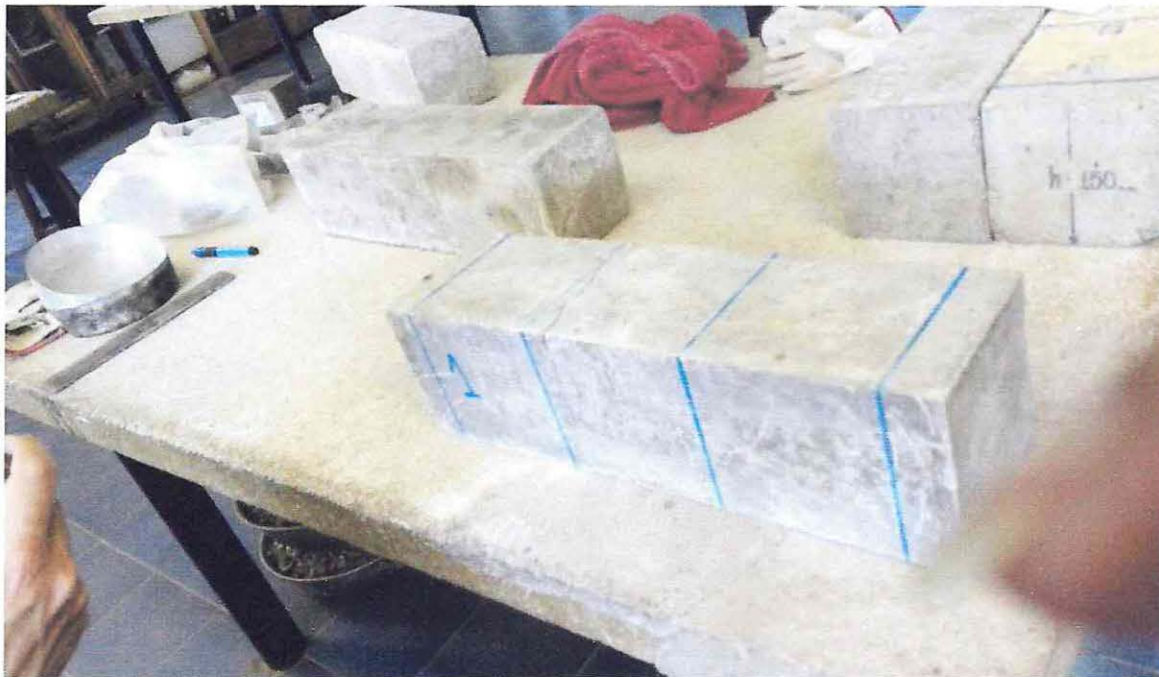
Figura 5.5 Probetas Prismáticas antes de ser ensayadas
