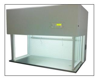
Figura 6.2.3 – Cámara de Flujo Laminar.
