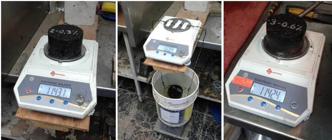
**Figura 4.6** – (Izq.) Pesaje de probeta en seco. (Centro) Pesaje de probeta sumergida en agua. (Der.) Pesaje de probeta en estado saturado superficialmente seco.
