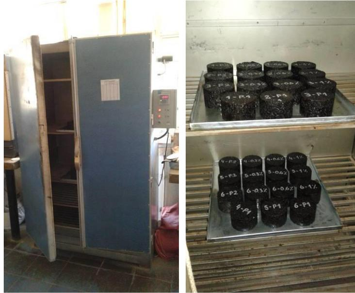
**Figura 4.10** – (Izq.) Horno de aire forzado utilizado para curar las probetas. (Der.) Vista interior del Horno de aire forzado.
