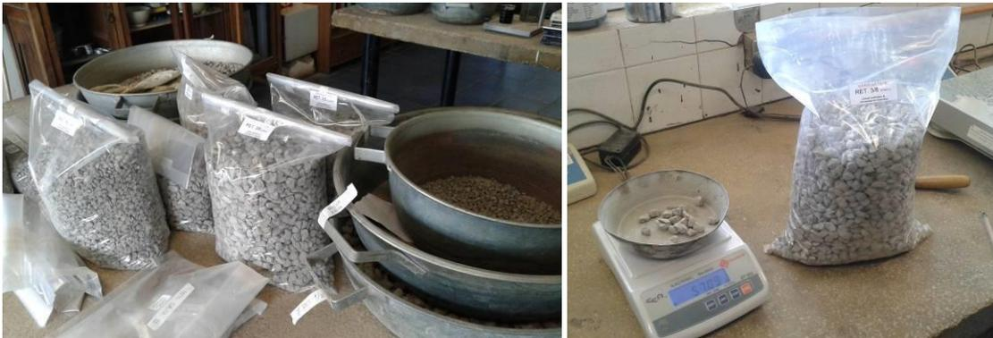
**Figura 4.2** – (Izq.) Separación de áridos según tamaño, luego de tamizado, para reconstitución granulométrica. (Der.) Pesaje de las fracciones de árido para formar muestras de 1100 g. de árido en granulometría semidensa e incorporación de zeolita.
