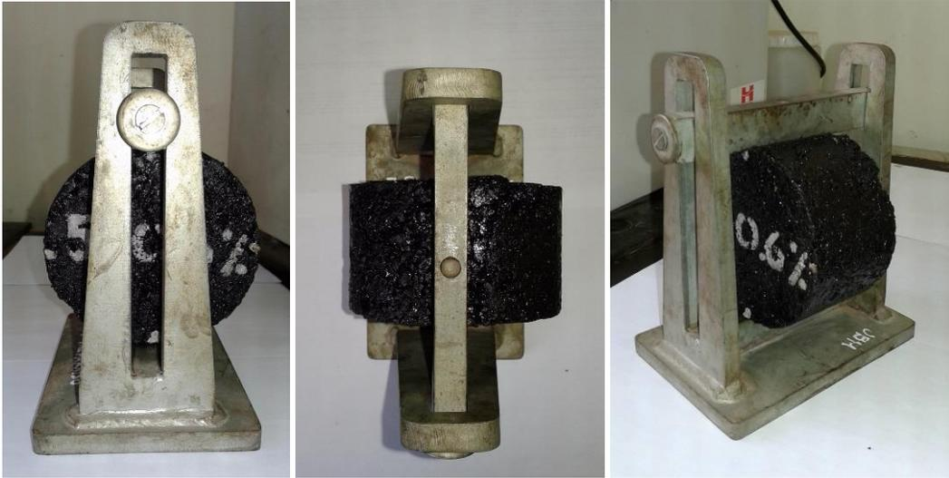
**Figura 4.11** – Vista lateral, superior y frontal del cabezal de ruptura utilizado en el ensaye de tracción indirecta. Se observa la disposición de la probeta para recibir carga en un plano axial.
