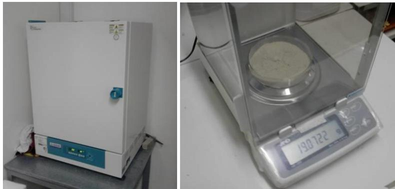
**Figura 4.12** – (Izq.) Horno utilizado para deshidratación de muestras. (Der.) Pesaje en balanza de precisión de las muestras de zeolita.
