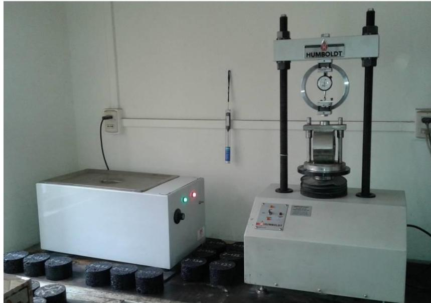
**Figura 4.7** – Equipo utilizado para el ensaye Marshall. Se observa a la izquierda el Baño de agua y a la derecha la máquina Marshall de aplicación de carga con indicador análogo de estabilidad y fluencia.
