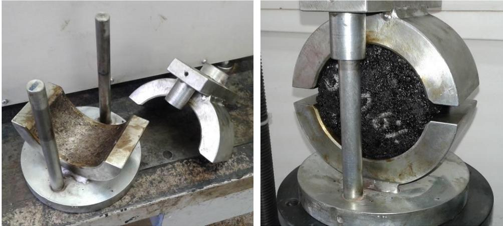
**Figura 4.8** – (Izq.) Mordaza desmontada para su lubricación y disposición de la probeta de ensaye. (Der.) Probeta de mezcla asfáltica montada en el cabezal de ruptura Marshall.
