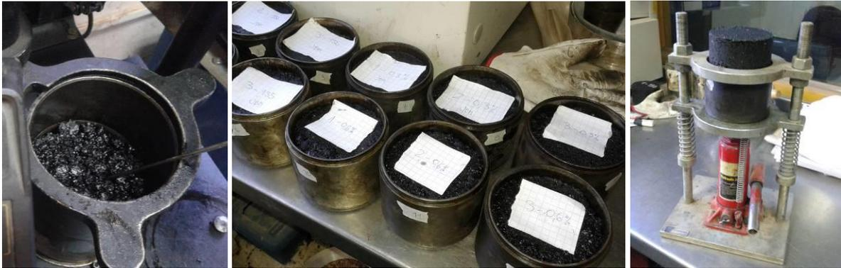
**Figura 4.5** – (Izq.) Muestra de mezcla asfáltica dentro del molde de compactación. (Centro) Algunas probetas compactadas en proceso de enfriamiento. (Der.) Herramienta hidráulica para extracción de probetas de moldes.
