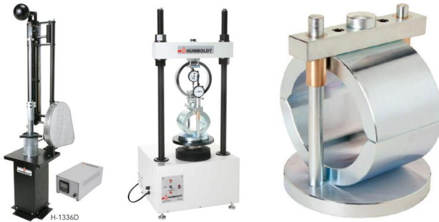
**Figura 2.3** – (Izq.) Compactador automático de impacto (martillo Marshall) con base estacionaria para moldes de 4". (Centro) Máquina Marshall de aplicación de carga con indicador análogo de estabilidad y fluencia. (Der.) Cabezal de ruptura o mordaza Marshall.
