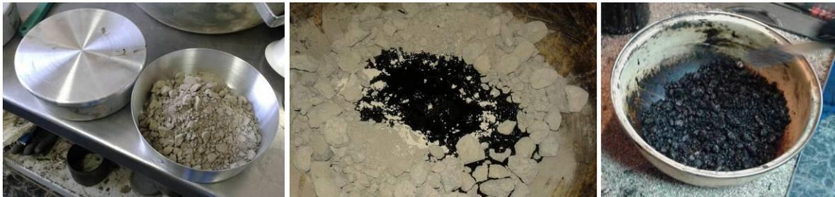
**Figura 4.3** – (Izq.) contenedores de aluminio para calentado en horno de muestras de 1100 g. de árido. (Centro) Vista del interior del bol de mezclado en donde se aprecian los materiales constituyentes previo al proceso de mezclado. (Der.) Mezcla asfáltica sin compactar.
