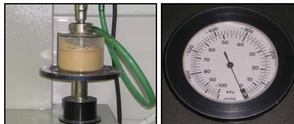
Figura N° 56 – 57: Mezclado – Reloj de vacío (funcionando)
