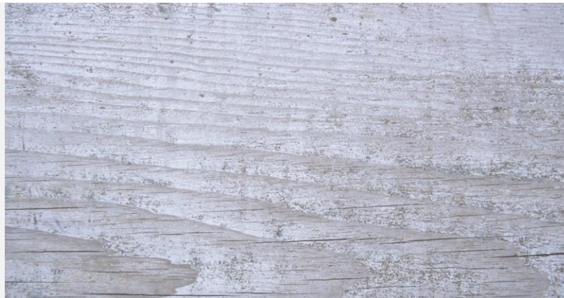
Figura 5. 2 - Baba con cal en madera de pino después de un mes.
