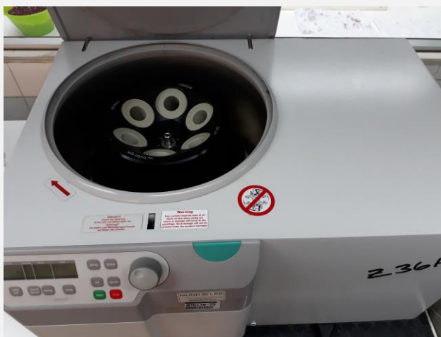
Figura 4. 8 - Centrifuga Herme modelo Z326. Fuente: Elaboración propia derivada de esta investigación.
