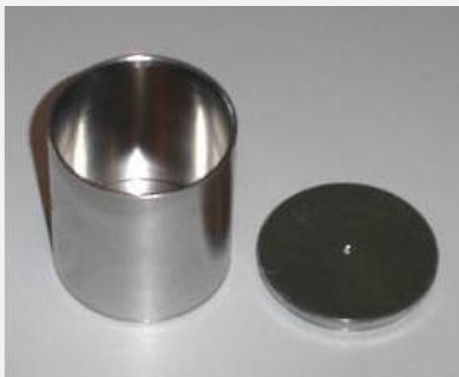
Figura 4. 6 - Recipiente metálico usado como picnómetro. Fuente: Elaboración propia derivada de esta investigación.
