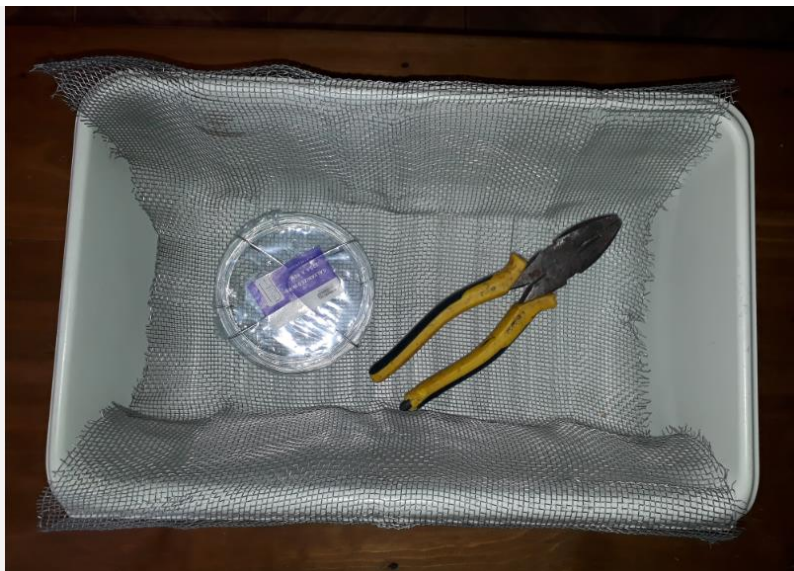
Figura 4. 33 - Materiales ensayo determinación de la absorción de agua y del hinchamiento.
