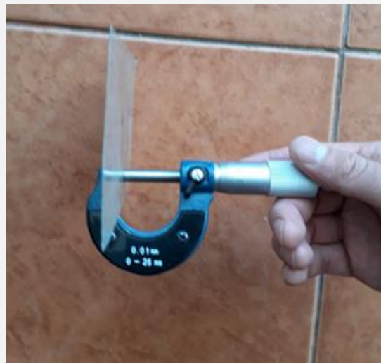
Figura 4. 21 - Medición del espesor de la película seca.
