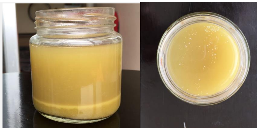
Figura 4. 16 - Ensayo de estabilidad Baba de nopal 30 días.
