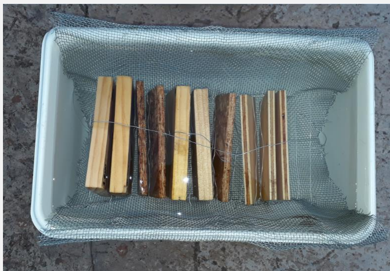
Figura 4. 34 - Probetas sumergidas durante el ensayo de absorción.
