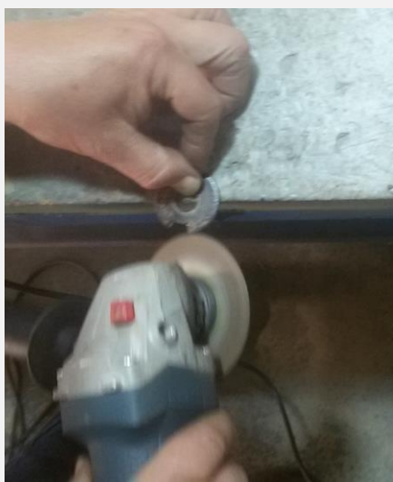
Figura 4. 26 - Pulido herramienta de corte 45^\circ .
