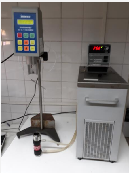
Figura 4. 7 - Viscosímetro BROOKFIELD LVDV-II+. Fuente: Elaboración propia derivada de esta investigación.
