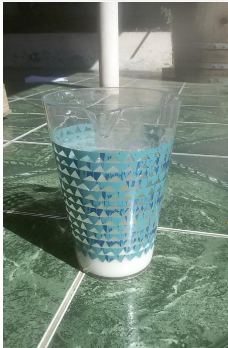
Figura 5. 4 - Mezcla de baba con chuño 48 horas después.
