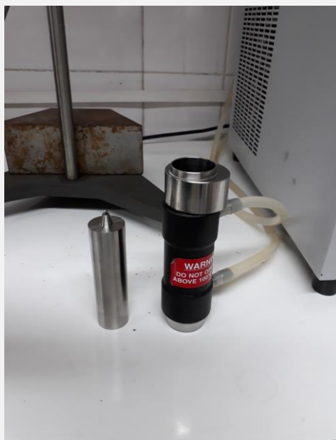
Figura 4. 9 - Aguja ULA y Camisa Envolvente. Fuente: Elaboración propia derivada de esta investigación.
