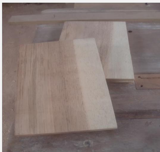
Figura 5. 3 - Mezcla de Baba de nopal con chuño sobre madera natural pino sin secar.
