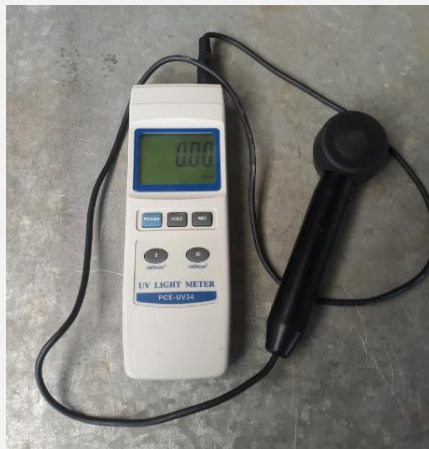
Figura 4. 17 - Radiómetro para medir la irradiancia en \text{mW}/\text{cm}^2 .
