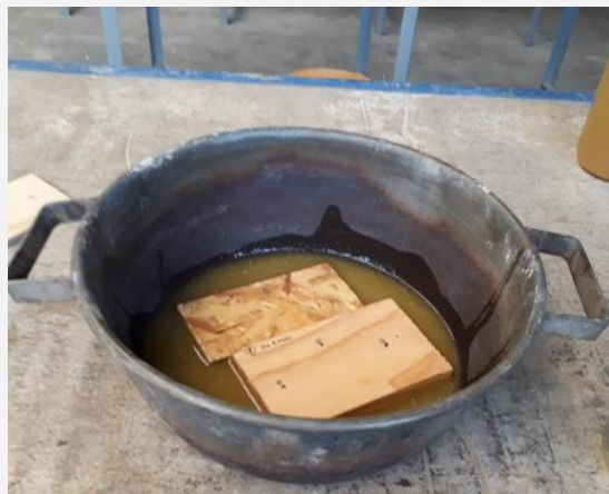
Figura 4. 29 - Probetas sumergidas en Baba de Nopal.
