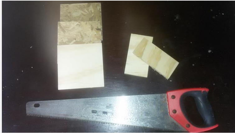
Figura 4. 2 - Corte de probetas.
