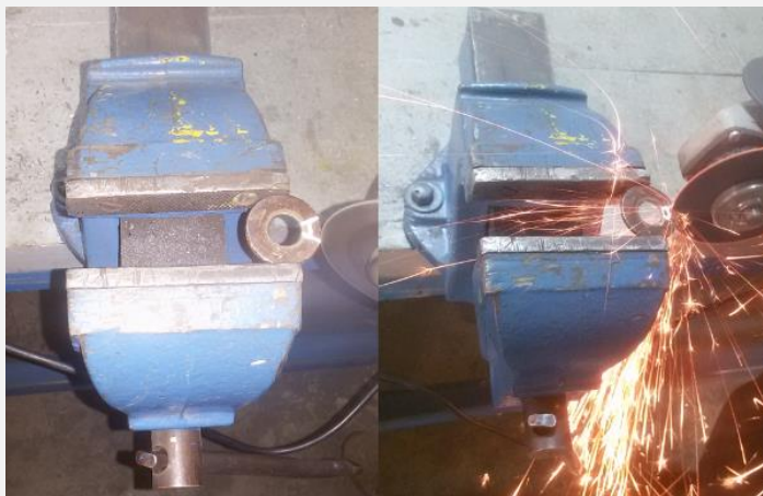
Figura 4. 25 - Elaboración herramienta de corte 45^\circ .
