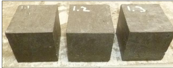
Figura 4.11: Selección de probetas L0, para comenzar proceso de ensayo de absorción. Fuente: Elaboración propia.
