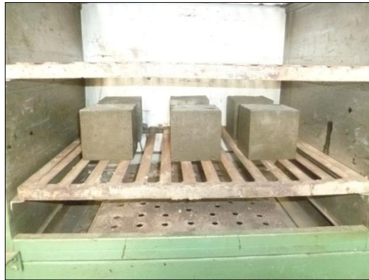
Figura 4.14: Probetas de L0 en horno a 110°C. Fuente: Elaboración propia.
