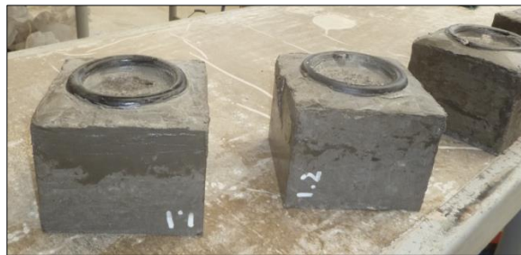
Figura 4.18: Probetas L0 con sello de goma pegadas con pasta de cemento con una razón de agua/cemento = 0,35. Fuente: Elaboración propia.
