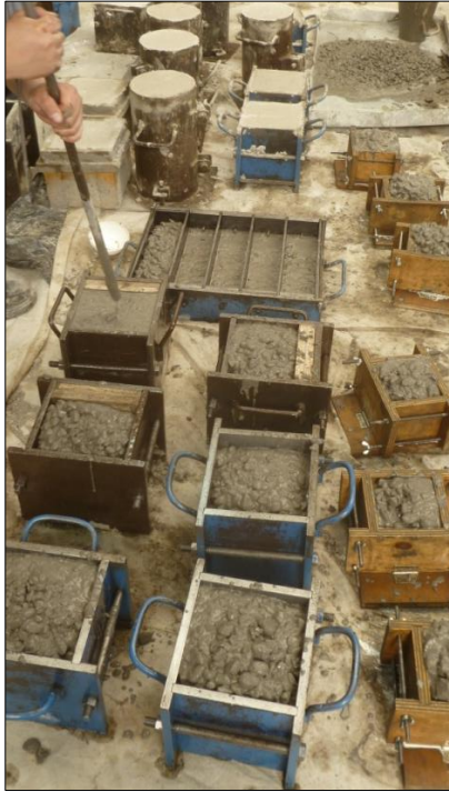
Figura 4.9: Compactación manual de hormigón L30. Fuente: Elaboración propia.
