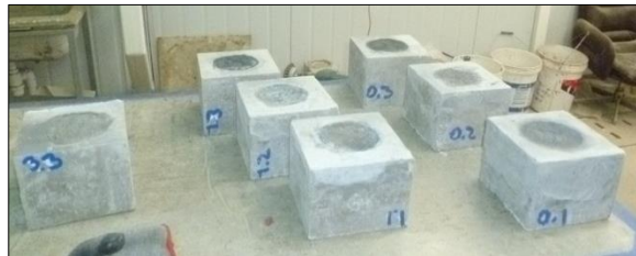
Figura 4.17: Probetas L0 y L10, raspadas con grata para hormigón. Proceso previo a la colocación de sello de goma para soportar la presión de agua. Fuente: Elaboración propia.
