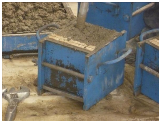
Figura 4.8: Compactación mecánica de hormigón L10. Fuente: Elaboración propia.
