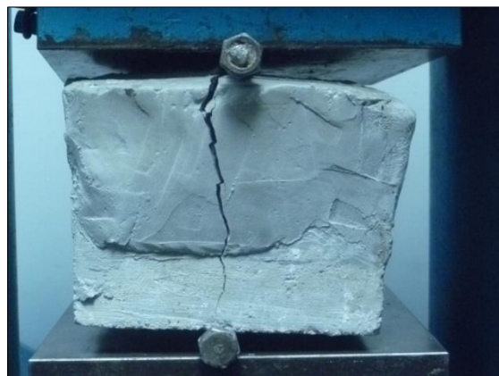
Figura 4.21: Fractura por hendimiento en L0. Fuente: Elaboración propia.
