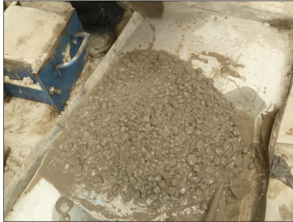
Figura 4.5: Situación luego de retirar cono en hormigón L30. Fuente: Elaboración propia.
