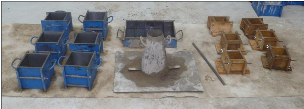
Figura 4.7: Disposición de probetas y cono, antes de vaciado de hormigón. Fuente: Elaboración propia.
