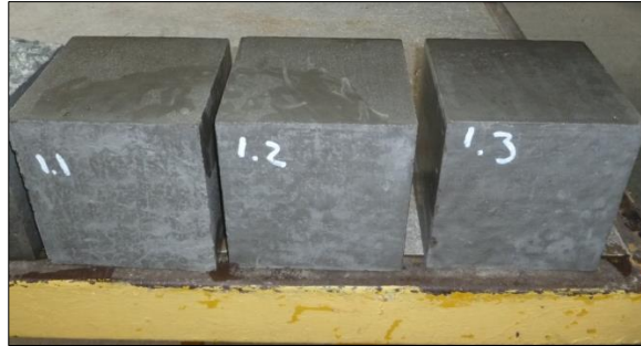
Figura 4.16: Selección de probetas L0, para comenzar proceso de ensayo de permeabilidad. Fuente: Elaboración propia.
