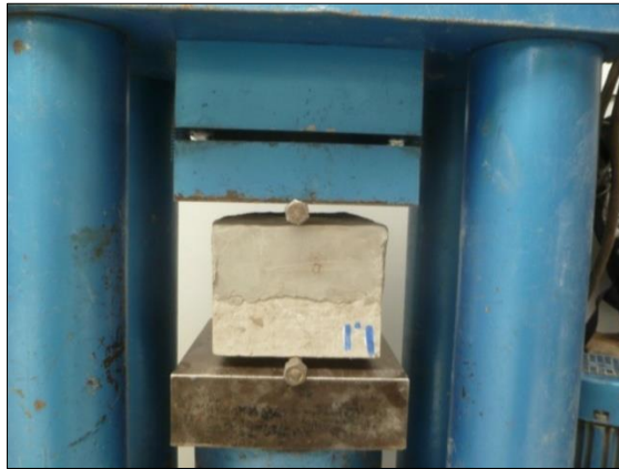
Figura 4.20: Proceso de rotura por hendimiento en L0. Fuente: Elaboración propia.
