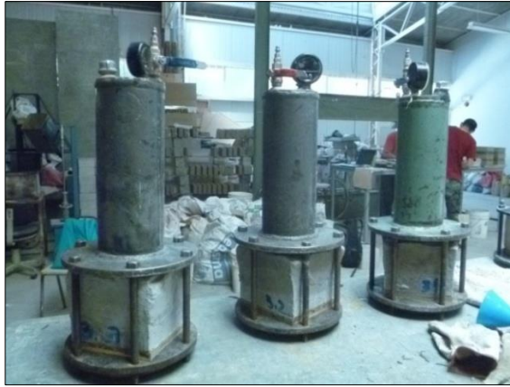
Figura 4.19: Montaje de ensayo de Permeabilidad de L10 a 0,5 MPa por 72 horas. Fuente: Elaboración propia.
