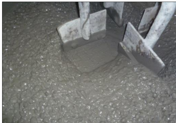
Figura 4.3: Amasado en Betonera de Eje Vertical. Hormigón L20. Fuente: Elaboración propia.
