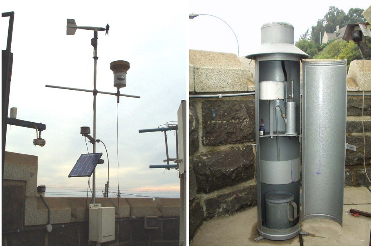
Fig. 5.3 Izquierda: Estación de monitoreo meteorológico Campbell Scientific y Derecha: pluviógrafo estándar.
