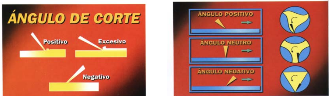
Fig.12: Ángulo de corte y correspondencia con secciones de instrumentos
