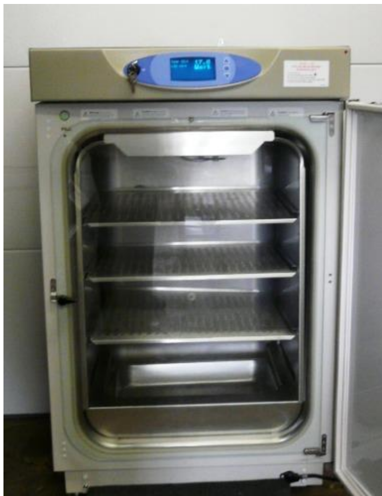
Figura 3.1 - Estufa incubadora Revco, modelo Elite II.
