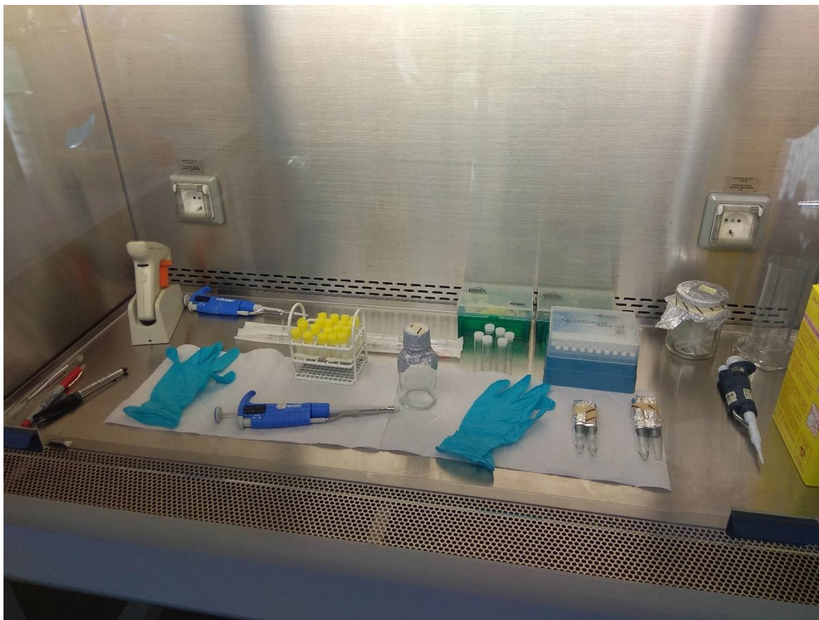
Figura 3.2- Cabina de seguridad tipo IIA (marca Nuair, modelo NU-425-400E) utilizada en el laboratorio de virología. Todos los insumos que se utilizan se irradian con luz UV para reducir al mínimo el riesgo de contaminación de los cultivos.
