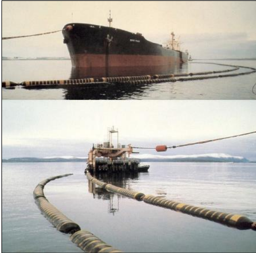
Figura 3.15. Manguera desmontable para el caso de una monoboya
