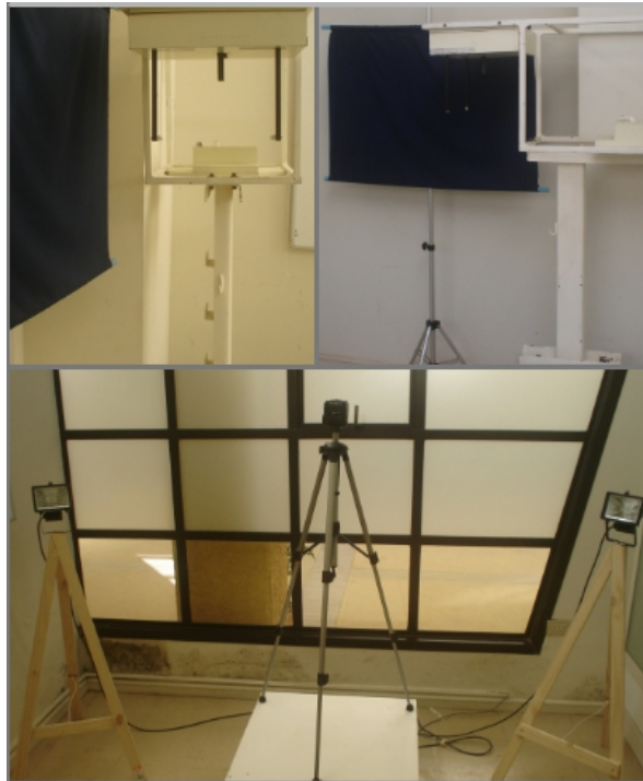
Fig. 12. Fotografía de la disposición de los materiales utilizados en la estandarización fotográfica. Arriba, el cefalostato en vista frontal y lateral; abajo, focos y trípode sobre la base diseñada para compensar la altura del cefalostato
