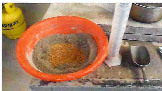
Figura 4.17: Mezcla mortero Corcho
