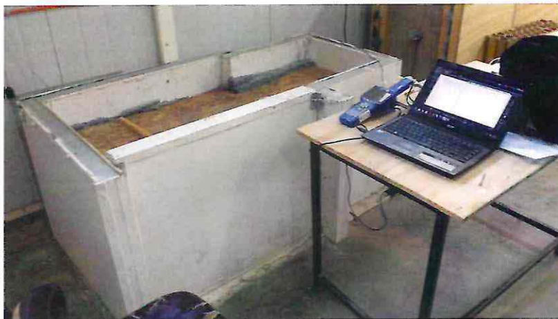
Figura 4.40: Cámara térmica ubicada en las dependencias de los laboratorios de hormigón
