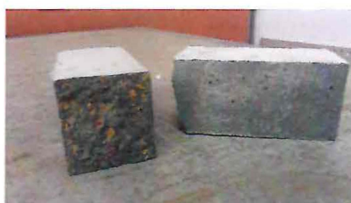
Figura: 4.26: Probeta sometida a flexión 70/30
