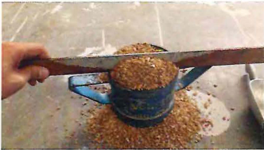
Figura: 4.12: Densidad Aparente Suelta Corcho
