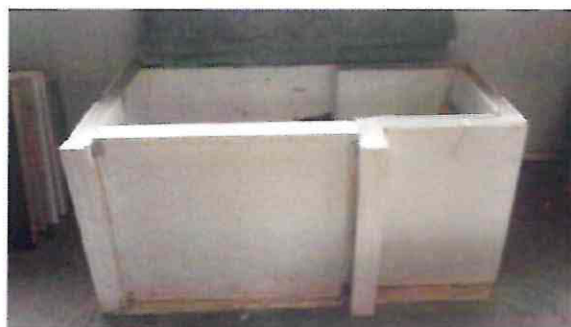
Figura 3.5: cámara térmica 50x50x150
