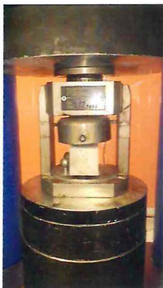
Figura 4.28: Probeta RILEMA en ensayo de Compresión
