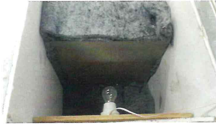
Figura 4.41: Ensayo térmico muro de albañilería
