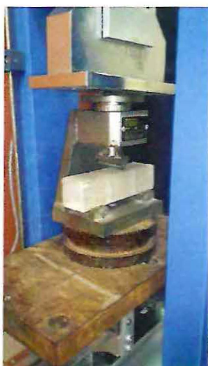
Figura 4.25: Probeta RILEM ensayo de Flexión
