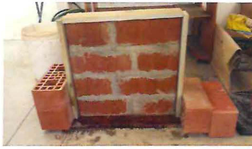
Figura 4.32: Muro de albañilería de ladrillos
