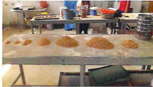
Figura 4.6 Tamizado Granulometría del Corcho
