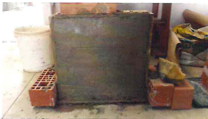
Figura 4.16: Muro revestido, mortero patrón
