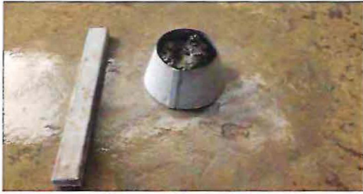
Figuran 4.19: Ensayo consistencia de mortero Figura 4.20: Muestra cono de la mesa de sacudida
