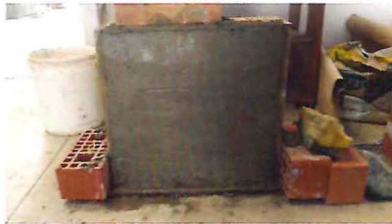
Figura 4.33: Muro de prueba de albañilería con mortero patrón
