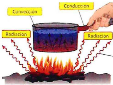
Figura 2.2: Esquema de mecanismos de calor
