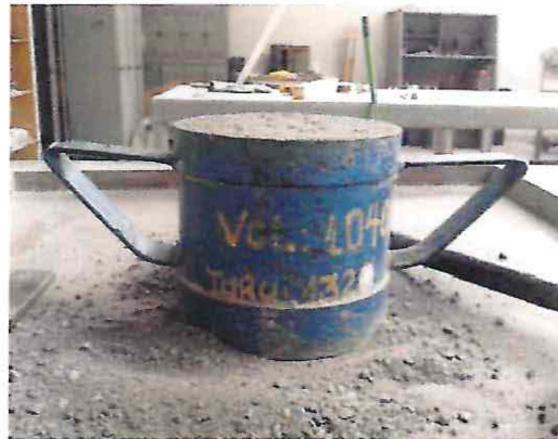
Figura 4.11: Recipiente para medir Densidad Aparente
