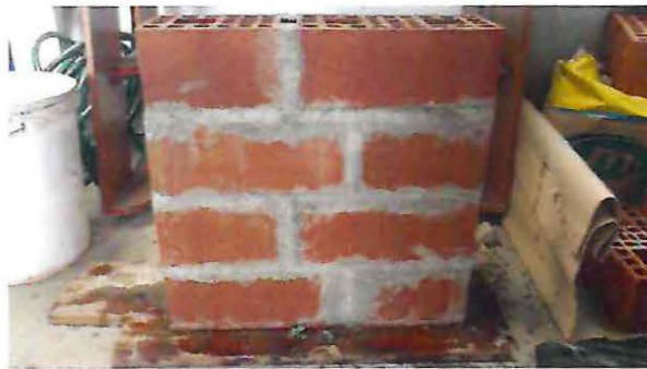
Figura 4.14: Muro de albañilería (50x50 cm)
