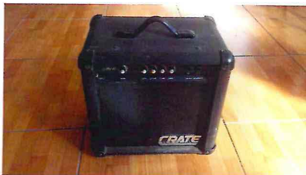
Figura 3.8: Sistema de sonido para emitir las frecuencias del ensayo
