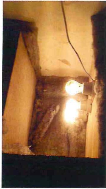
Figura: 4.44: Ensayo térmico muro de albañilería estucado con corcho reciclado
