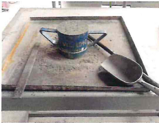
Figura 4.10: Densidad Aparente arena
