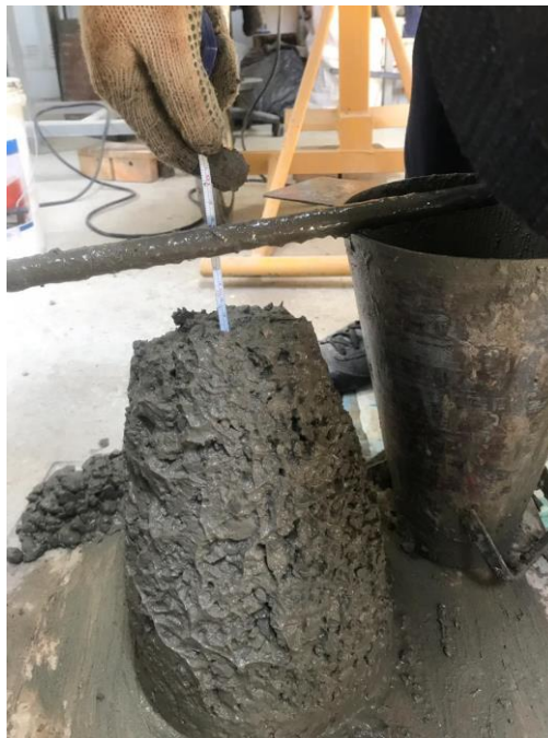
Figura 4.2. Método de asentamiento de cono
