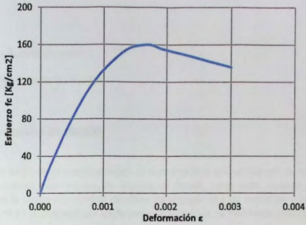
Figura 4.2 - Curva esfuerzo – deformación hormigón H-20.
