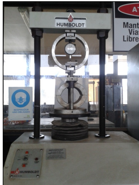
Figura 3.7: Ensayo Marshall. Bitumix s.a. planta Concón
