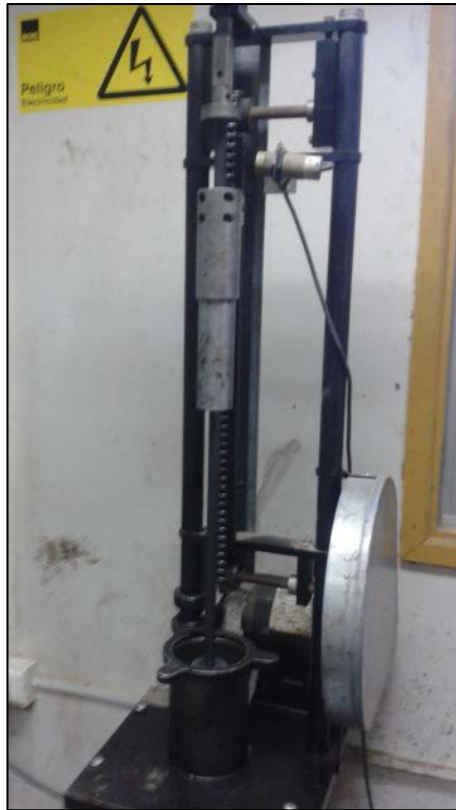
Figura 3.6: Martillo Marshall. Laboratorio de Vialidad, V Región.
