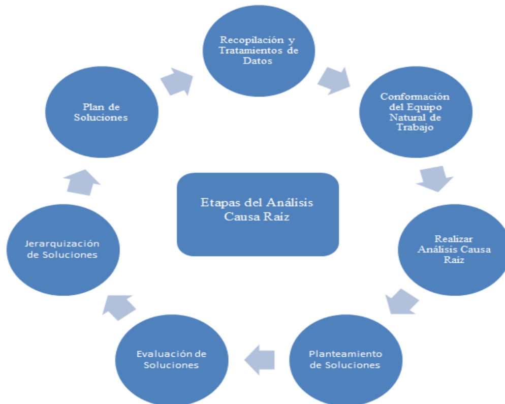
Figura 2.2 – Las siete etapas para la implementación del Análisis Causa Raíz. (Reliability and Risk Management, 2018)
