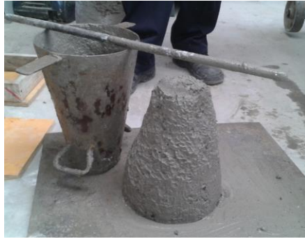
Figura 5.2: Asentamiento de Cono Hormigón Patrón
