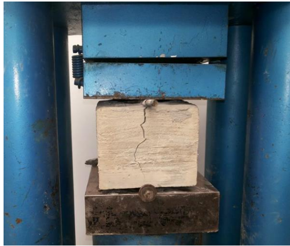
Figura 5.16: Rotura de la Probeta
