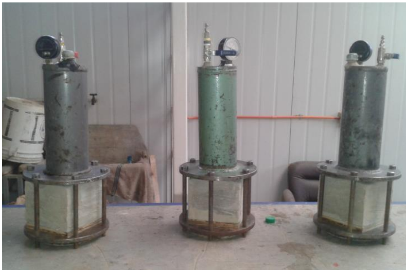
Figura 5.15: Ensayo de Permeabilidad
