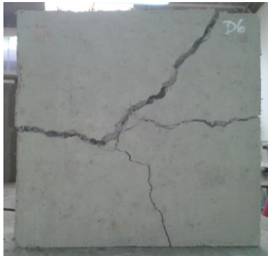
Figura 5.21: Probetas estudio 2,5 kg/m 3 Resistencia al impacto
