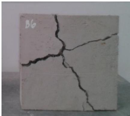
Figura 5,19: Probetas Estudio 1,5 kg/m 3 Resistencia al impacto
