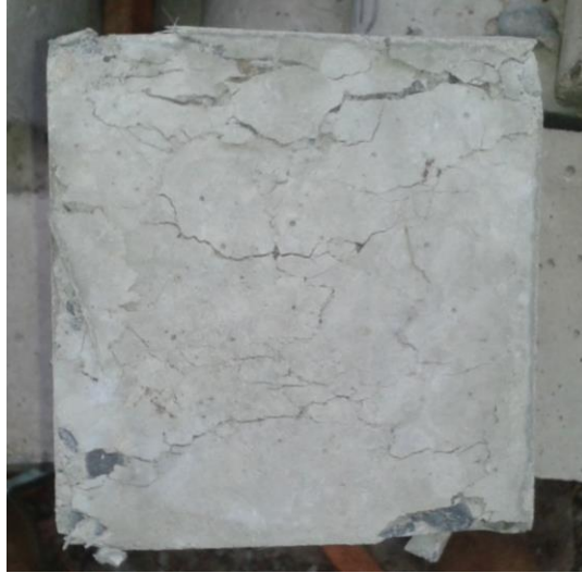
Figura 5.10: Probeta de Compresión Con Adición de Fibras
