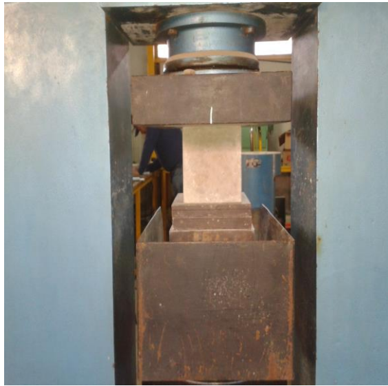
Figura 5.8: Ensayo de Compresión
