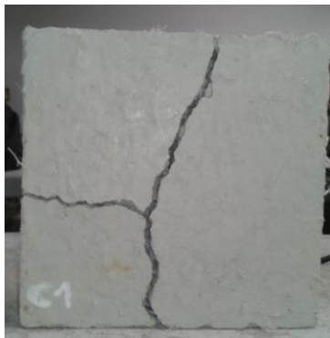
Figura 5.20: Probetas Estudio 2,0 kg/m 3 Resistencia al impacto
