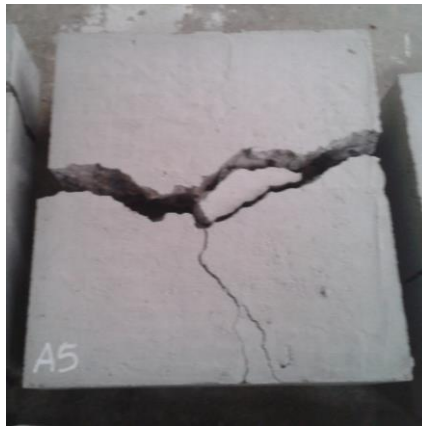
Figura 5.18: Probetas, Hormigón Patrón. Resistencia al Impacto
