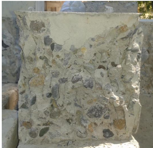
Figura 5.9: Probeta de Compresión Sin Adición de Fibras
