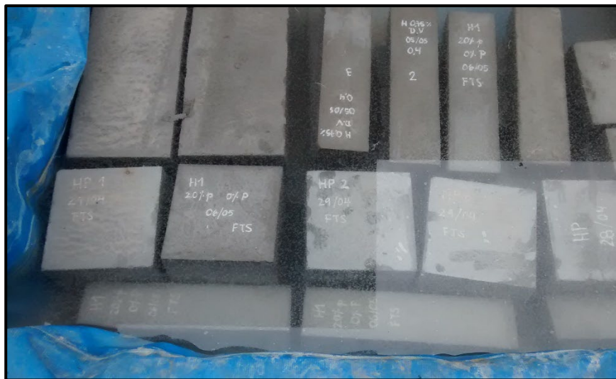
FIGURA 4.6: Curado por inmersión en agua con cal.
