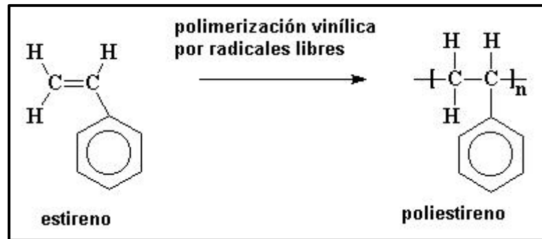
FIGURA 2.1: Proceso de polimerización vinílica por radicales libres
