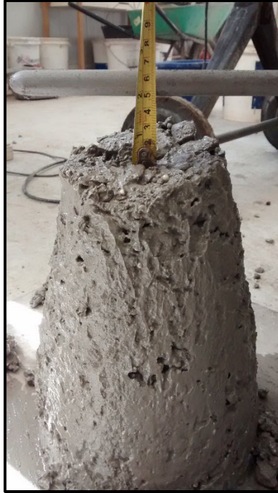
FIGURA 4.4: Método de asentamiento de cono de Abrams para la determinación de la docilidad.
