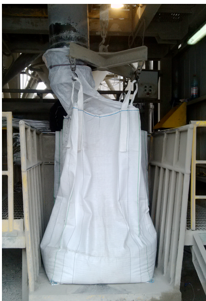
Figura III.5.2: Proceso de llenado de bigbags, Cemento Melón, Planta La Calera.
