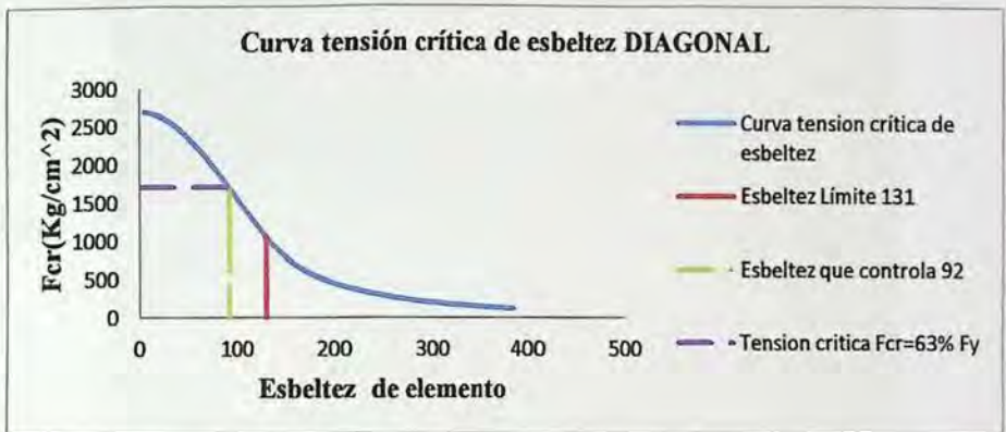
Figura 4.2: Curva de tensión crítica esbeltez en diagonales.
