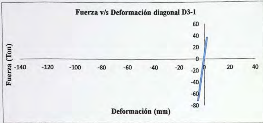
Figura 5.20: No linealidad en diagonal D3-1 fuerza deformación.
