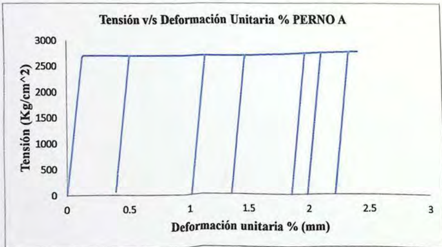
Figura 5.24: No linealidad en pernos A tensión deformación unitaria.
