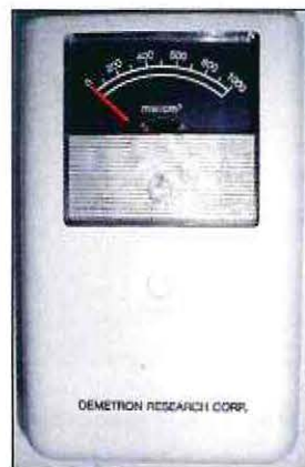
Radiómetro análogo Demetron Model 100.
