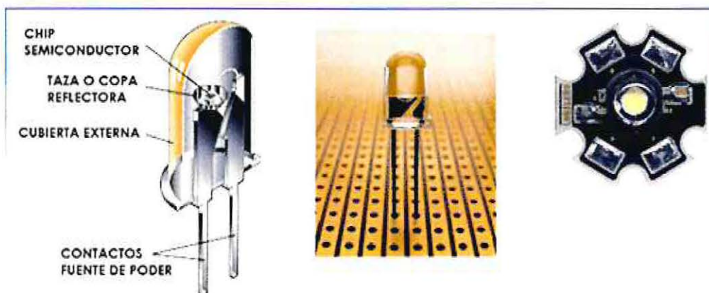
Figura 17. Estructura de un LED y dos formas comunes (Modificado de Craford y cols, 2001).
