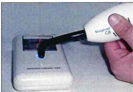
Medición de la irradiancia con Bluephase C8.
