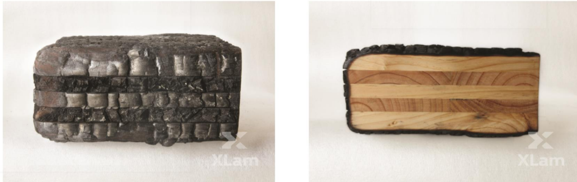
Figura 2.6 - Panel de CLT estructuralmente intacto después de ser sometido al fuego [36].
