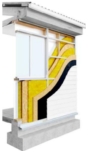
Figura 23: Detalle constructivo de solución térmica para muros perimetrales de tabiquería madera – Fuente: MINVU
