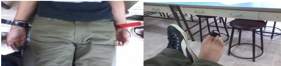
Figura 14: Sensores de Pulso situados en el dedo medio de la mano derecha y en el ortejo principal del pie derecho, en las muñecas se utilizaron electrodos para tomar el ECG del voluntario a modo de referencia.
