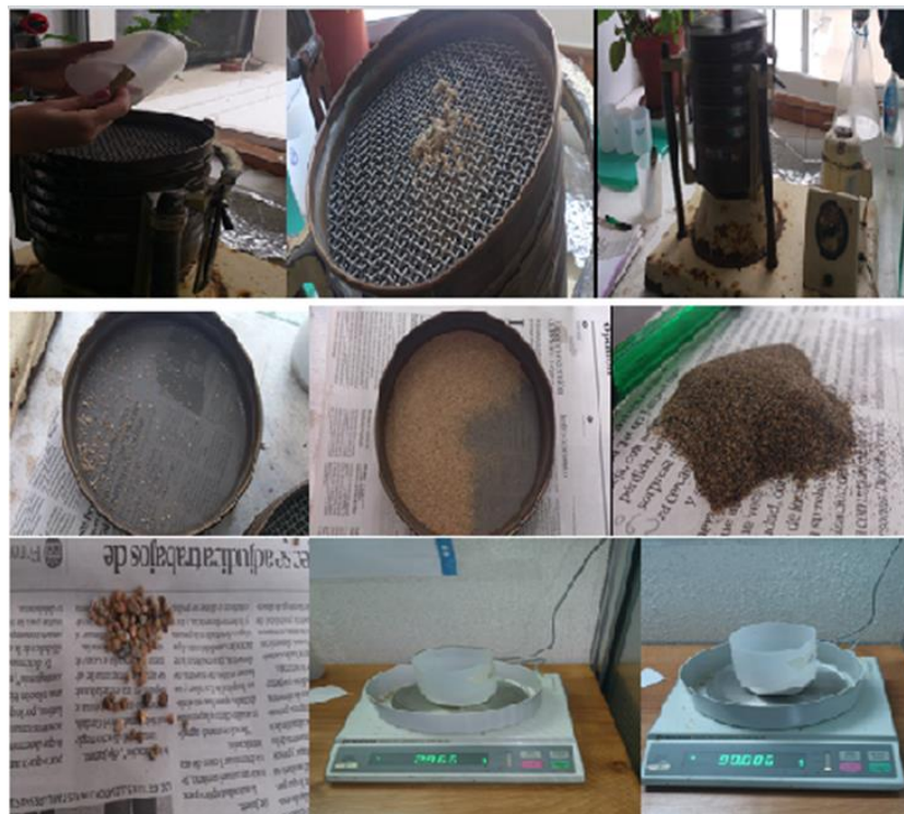
Figura 10-3: Proceso de Tamizado
