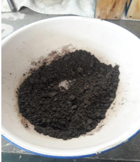
Figura 10: Mezcla nº 8 de la tabla nº 16 para porcentaje de emulsión 5,7%. Fuente: Elaboración propia, 2017.
