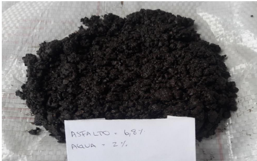
Figura 12 Mezcla nº 10 para porcentaje de emulsión 6,7%. Fuente: Elaboración propia, 2017.
