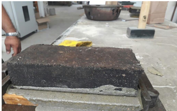
Figura 15 Probeta refrentado con azufre. Fuente: Elaboración propia, 2017.
