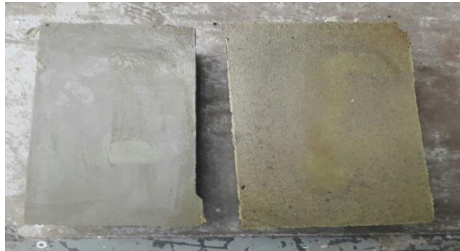
Figura 16: Probeta ensayada a tracción.
