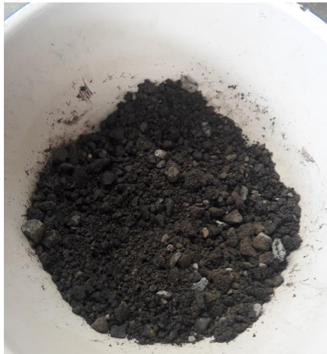
Figura 9 Mezcla nº 4 de la tabla 14 para porcentaje de emulsión 4,7%.
