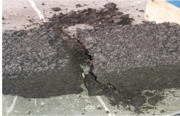
Figura 14: Probeta fracturada por baja resistencia. Fuente: Elaboración propia, 2017.
