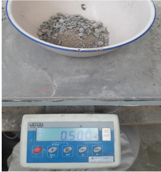
Figura 8: Masa muestral para encontrar porcentaje óptimo de emulsión.
