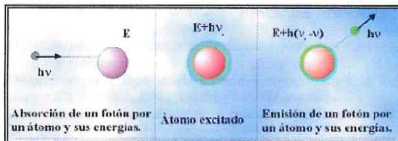
Fig. 2. Esquema del fenómeno de fluorescencia.
