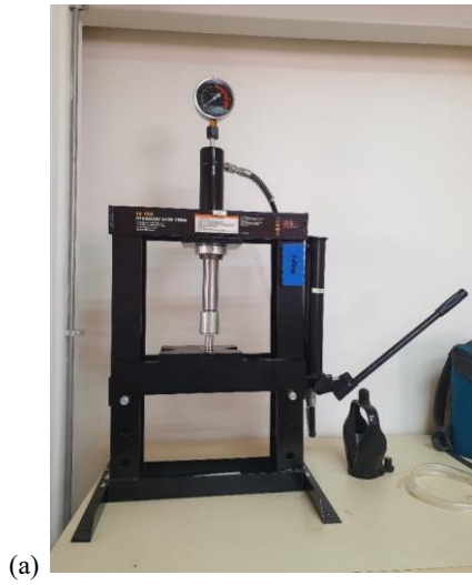
Anexo 9: a) Prensa hidráulica b) Pellet de MoS 2 - Universidad de Valparaíso. Elaboración propia
