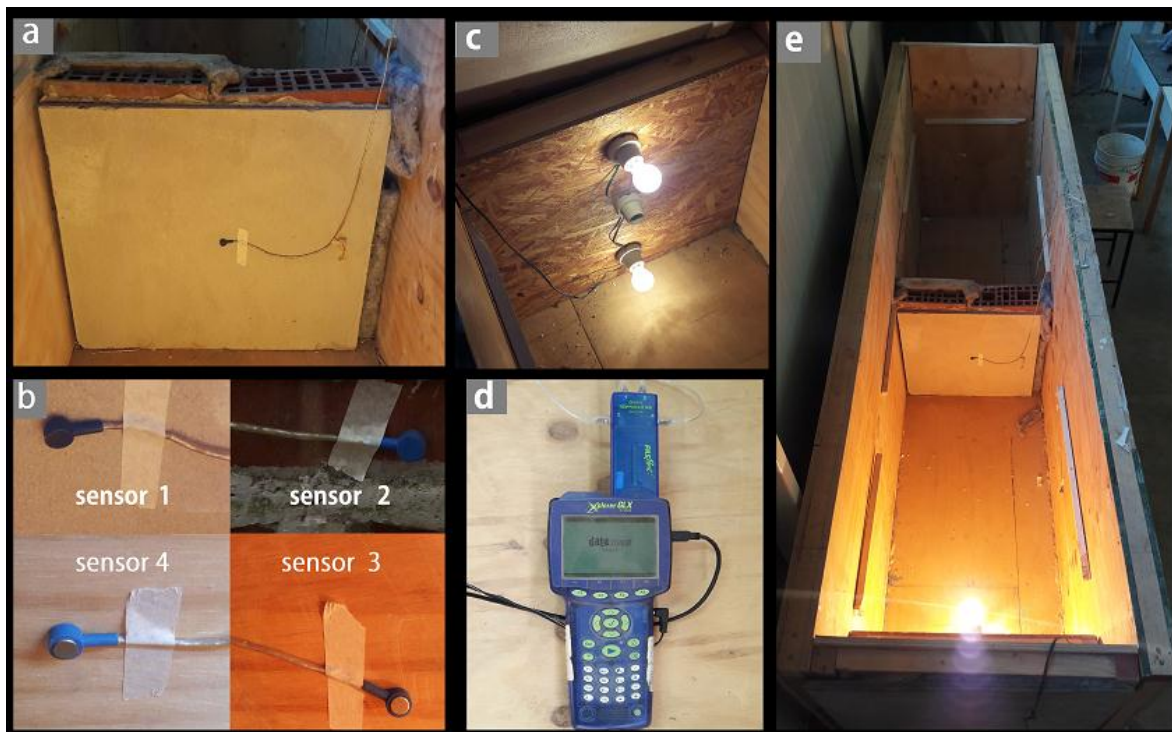
Figura 4. 2448: (a) bloque de albañilería dispuesto dentro de la cámara, (b) sensores, (c) panel emisor de calor, (d) maquina, (e) cámara de ensayo.
