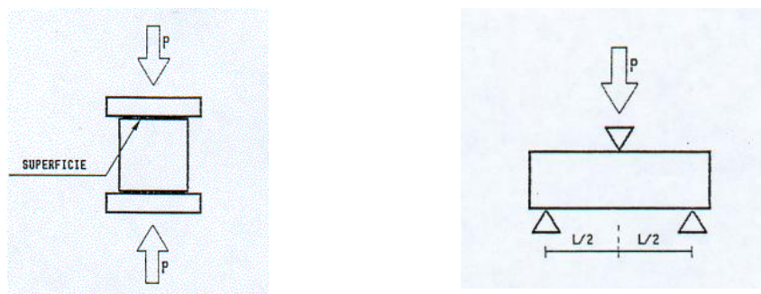
Figura 3. 2: Ensayo de Compresión y Flexión en probeta RILEM.
