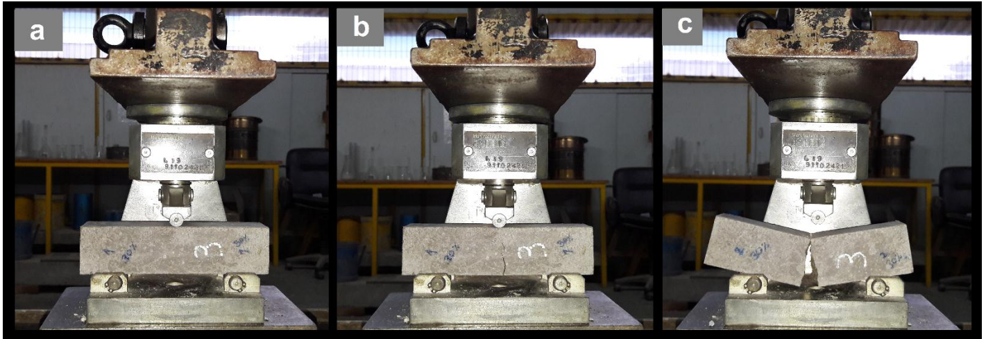
Figura 4. 1633: (a), (b), (c) Secuencia del procedimiento ensayo de flexión, probeta RILEM con 70/30 porcentaje de arena/musgo.
