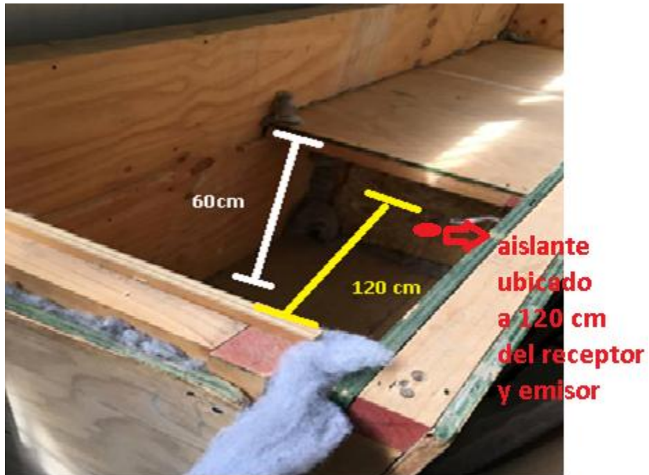
Figura 5.4.3.- Montaje de aislante a 120 cm del emisor y receptor.
