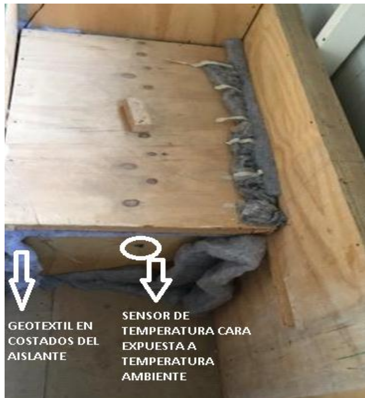
Figura 5.3.2.- Aislante dentro de la cámara de ensayo.
