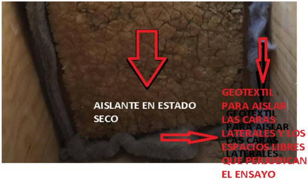
Figura 5.3.1.- Aislante dentro de la cámara antes de ser ensayado.
