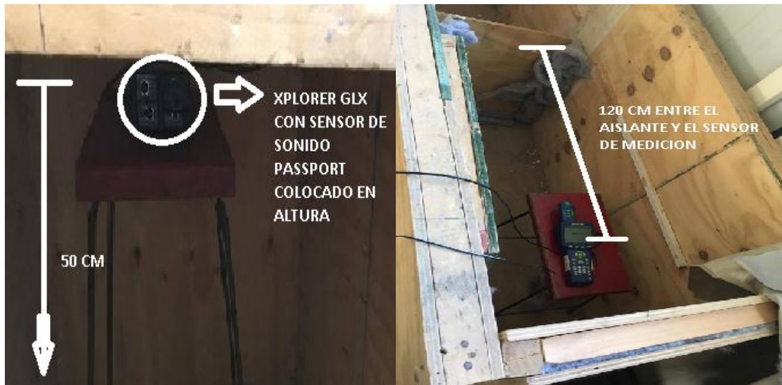
Figura 5.4.1: XPLORER GLX con PASSPORT de sonido a 120 cm del aislante.
