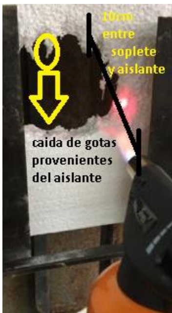
Figura 5.5.3.-Ensayo ignifugo en aislante tipo aislapol.
