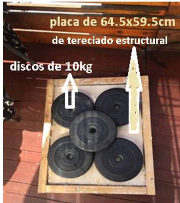
Figura 5.2.2.2.- Probeta compactada con discos.
