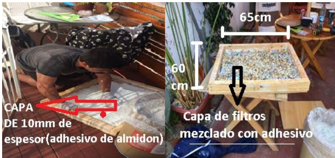
Figura 5.2.2.1.-Capa de 5mm de adhesivo y filtros mezclados con adhesivo.
