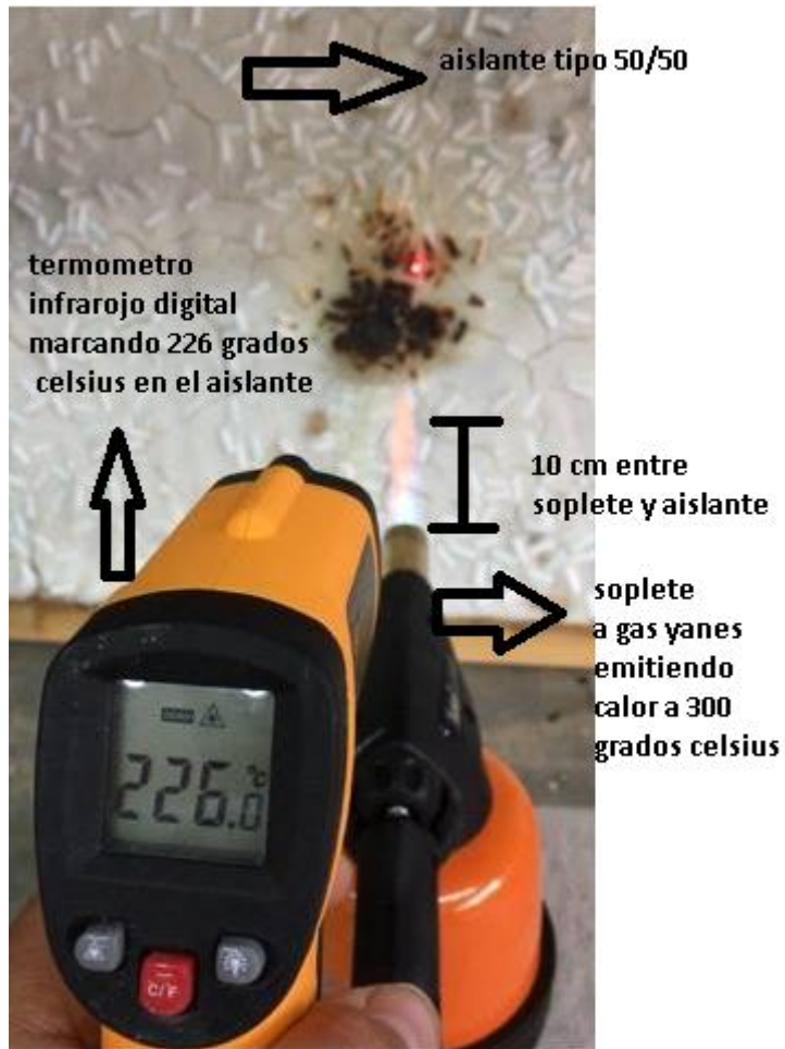
Figura 5.5.1.- Ensayo ignifugo en aislante tipo 50/50 (de dosis).
