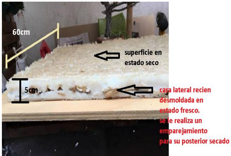
Figura 5.2.2.3.- Aislante desmoldado después de 24 horas, listo para ensayar.
