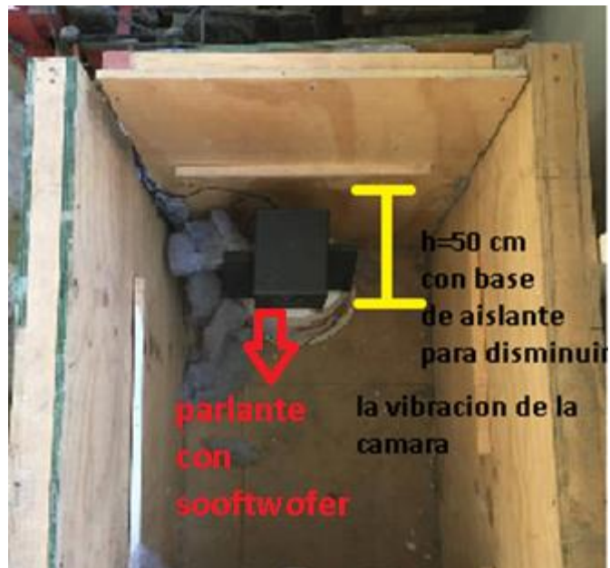
Figura 5.4.4.- Emisor de sonido ubicado en altura dentro de la cámara aislada.
