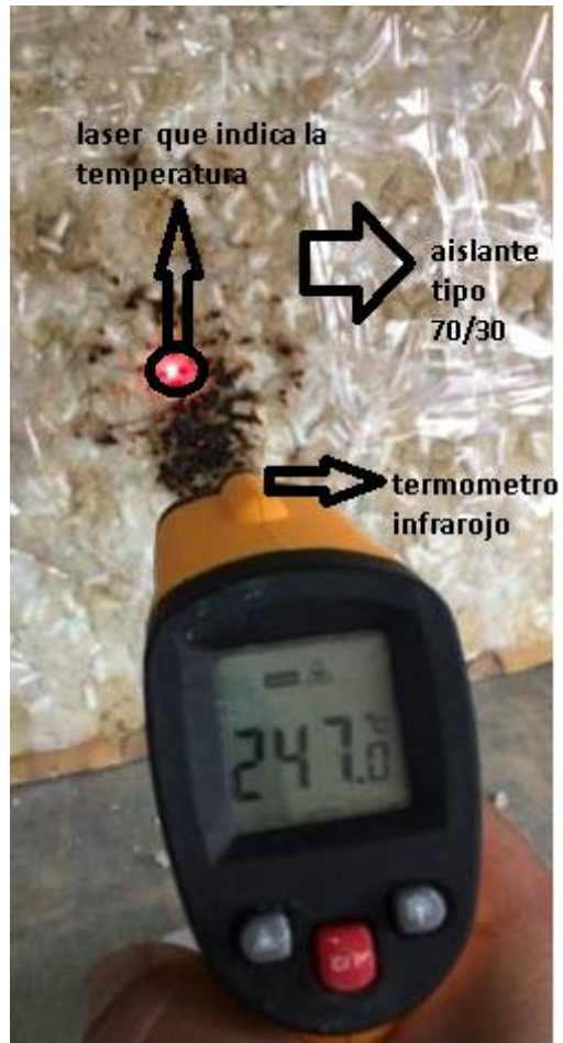
Figura 5.5.2.- Ensayo ignifugo en aislante tipo 70/30 (de dosis).
