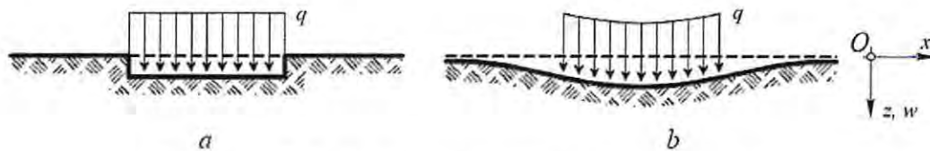
Figura 2.11 – Deflexión elástica del suelo bajo carga uniforme. [11].
